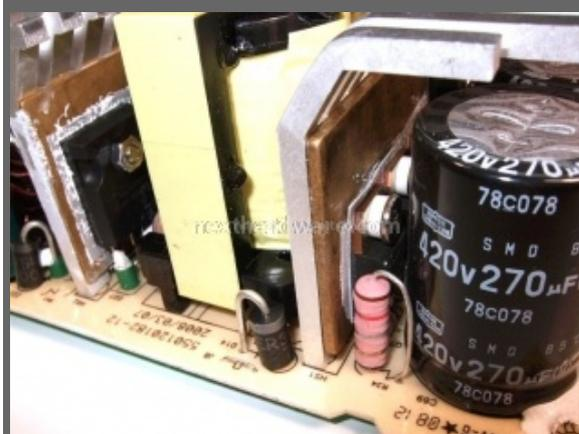
Grande cura e innovazione è stata posta nella progettazione dei dissipatori, possiamo notare come anche nel mondo degli alimentatori si stiano sfruttando sempre più le tecnologie utilizzate nei dissipatori per Cpu.
