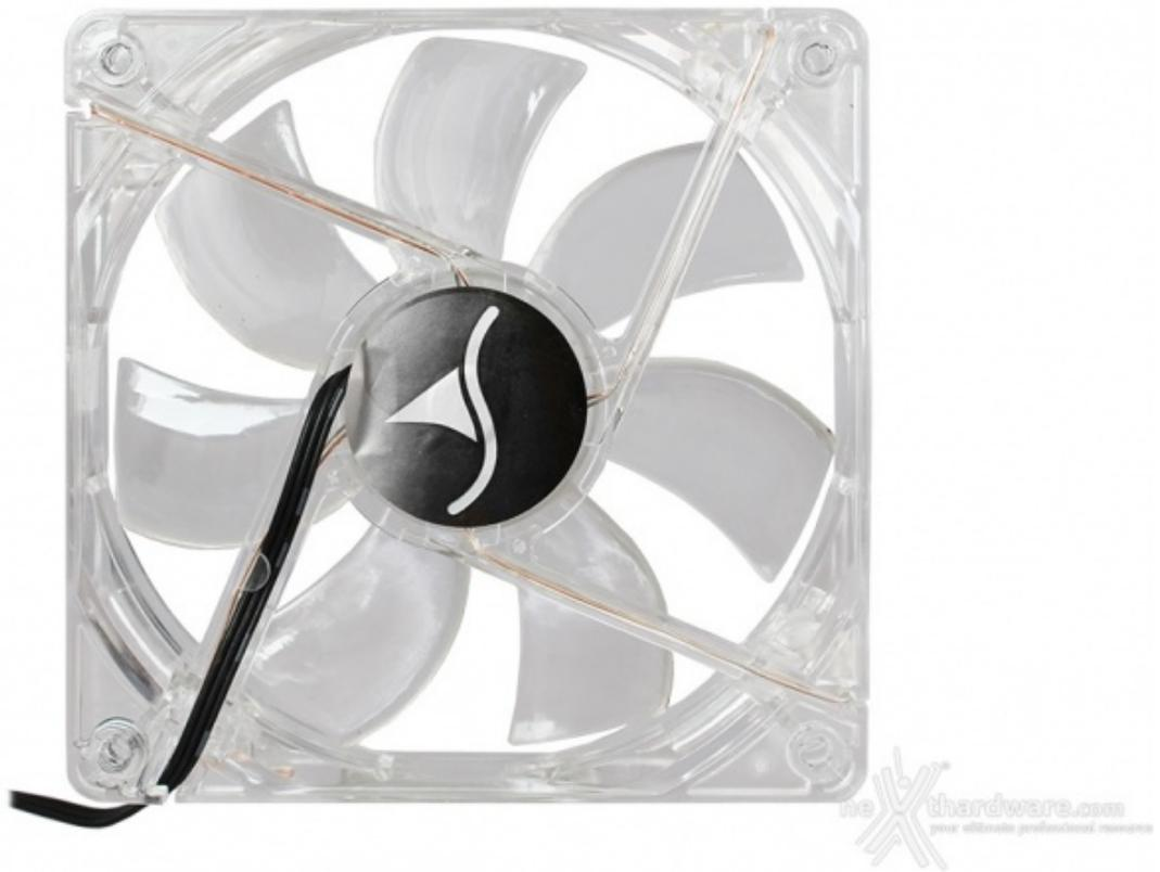
Posteriormente è invece montata una ventola da 120mm, trasparente e con LED blu, anch'essa con connettore molex o 3pin.
