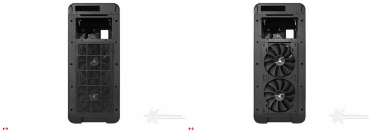
Rimosso il pannello frontale, possiamo accedere ad un generoso filtro antipolvere posto a protezione delle due unità da 140mm installate di serie.
