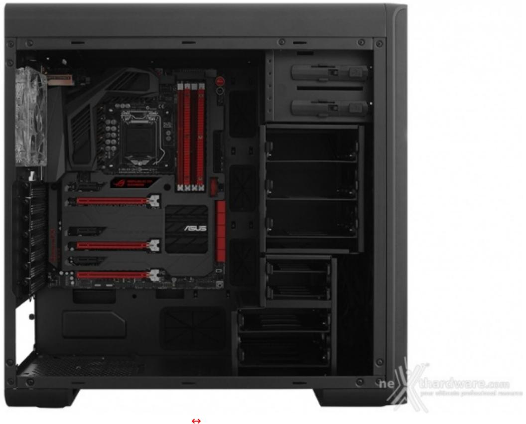
Il posizionamento della mainboard, date le dimensioni del case e la presenza di molti cestelli, può richiedere qualche manovra aggiuntiva poiché lo spazio ridotto non permette di avere una presa salda sul lato destro del PCB.
