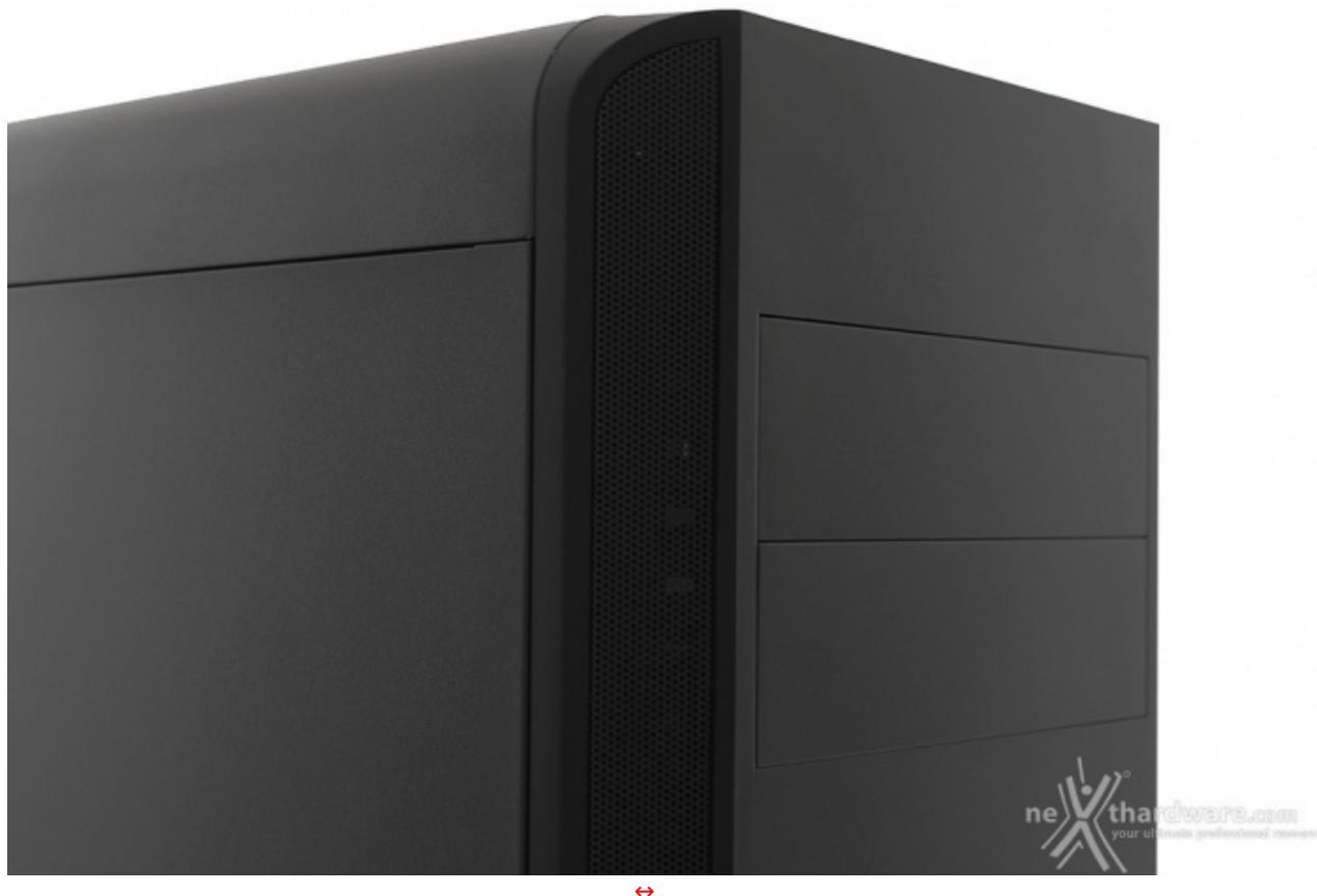
Quest'ultimo presenta due inserti in plastica a protezione delle predisposizioni da 5,25" nella parte alta, di cui uno sostituibile con il riduttore per periferiche da 3,5" fornito in dotazione, ed il logo Sharkoon in basso.
