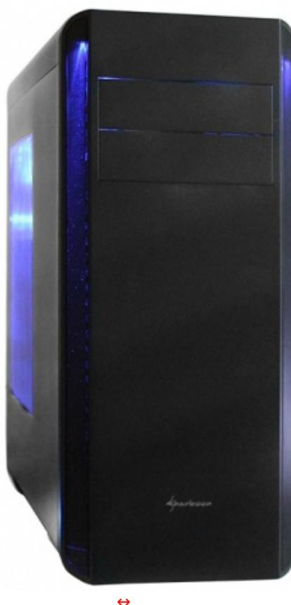
Una volta alimentato, lo Sharkoon BW9000-W si illuminerà di blu tramite una coppia di LED posizionati sul frontale ed i quattro LED della ventola posteriore.
