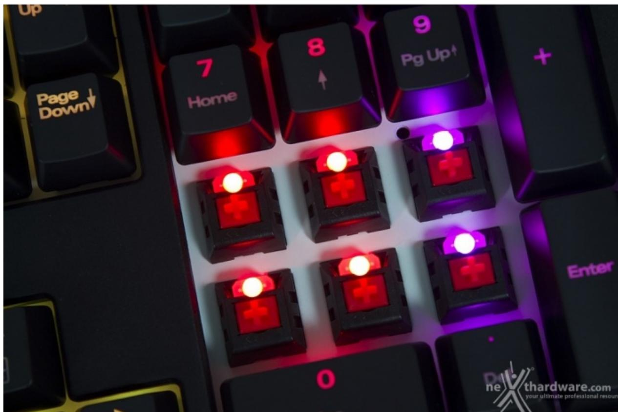
Qui sopra un dettaglio degli switch utilizzati, i Kailh modello MX Red.
