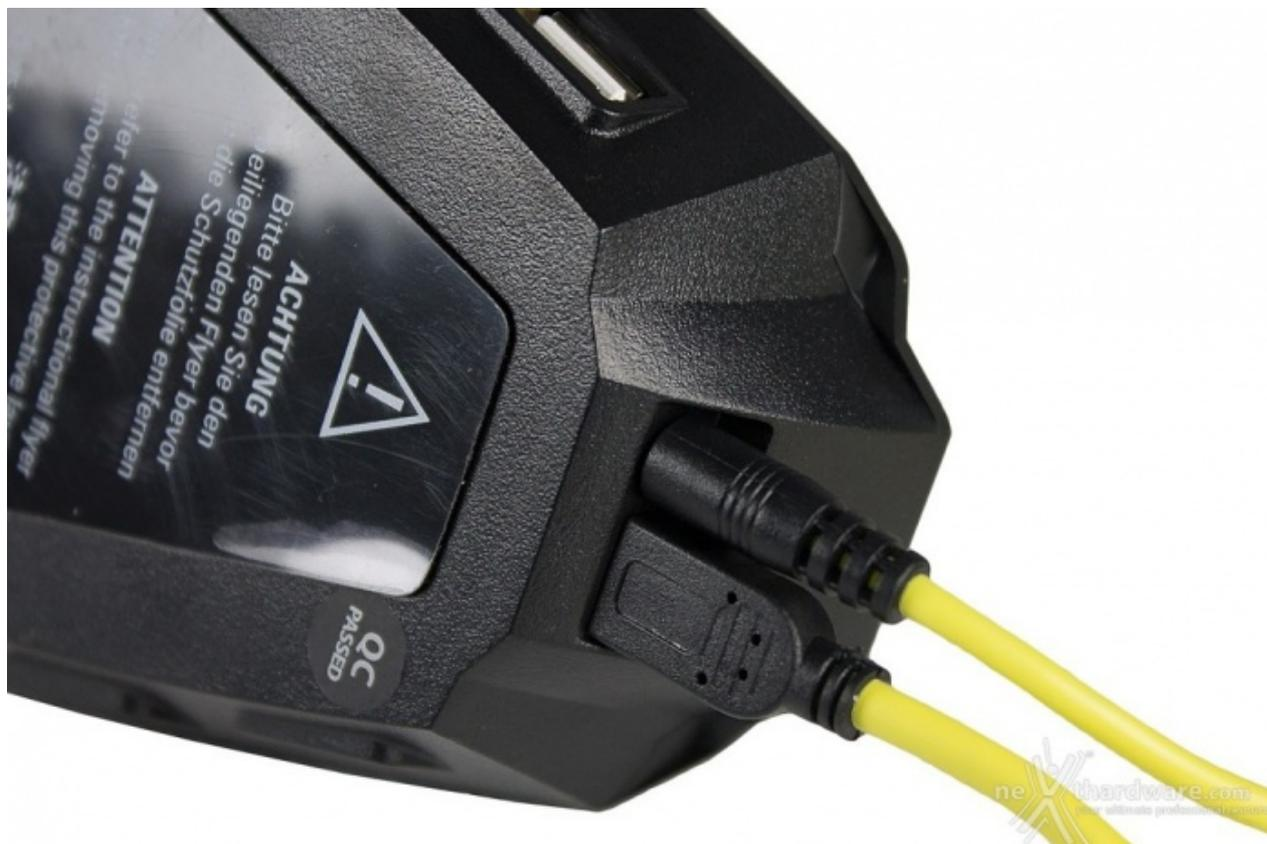
Sono due le connessioni necessarie al funzionamento dello SHARK ZONE MB10, ovvero un cavo USB-USB per il trasporto dei dati ed un cavo USB-DC per l'alimentazione.
