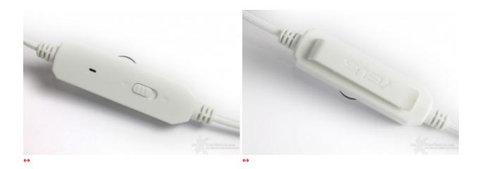
Seguendo il cavo, telato e di ottima fattura, giungiamo al controllo in linea, ovvero una piccola unità dotata di molletta per l'aggancio sui vestiti con integrati i controlli basilari come quelli per il volume e la disattivazione del microfono.
