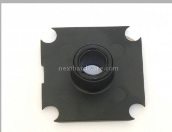
Particolare della parte superiore del diffusore. Ai quattro angoli i fori per la raccolta del flusso in uscita e al centro il condotto di ingresso. Si noti come alla sommità di quest'ultimo sia presente un guarnizione per incanalare correttamente il flusso verso la base.
