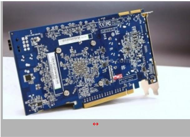
Le dimensioni del PCB sono piuttosto contenute. Il dissipatore è fissato alla scheda con le sole 4 viti visibili in foto, i due pushpin di plastica, sono invece impiegati per bloccare il piccolo dissipatore in alluminio che copre la sezione di alimentazione, posizionata nella parte anteriore della scheda.
