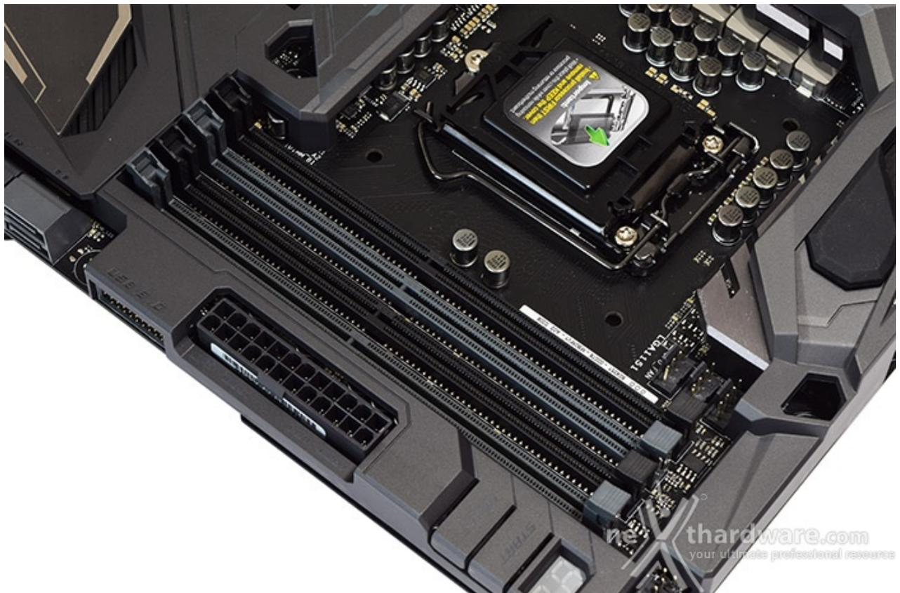
Da notare, infine, il particolare design degli stessi, che prevede il meccanismo di ritenzione solo sul lato esterno per consentire di smontare i moduli anche in presenza di una VGA installata sul primo slot PCIe.
