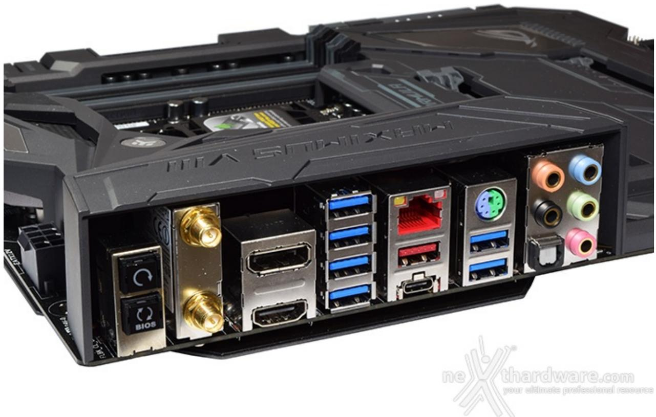
Il pannello di I/O della ASUS MAXIMUS VIII FORMULA è sormontato da una elegante cover in materiale plastico che, oltre a fornire una protezione meccanica, dovrebbe offrire una buona schermatura dalle emissioni elettromagnetiche per le varie porte.
