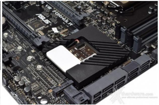
Un secondo dissipatore, di dimensioni più contenute, è quello preposto al raffreddamento del PCH Z170, all'interno del quale è stato alloggiato il circuito di gestione dell'illuminazione Aura.
