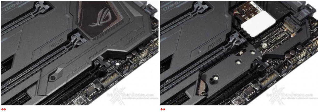
Per accedere al connettore M.2 PCIe, come visibile nelle foto in alto, dovremo rimuovere preventivamente una parte del ROG Armor fissata tramite una vite che, una volta installato il drive, potremo tranquillamente riposizionare.
