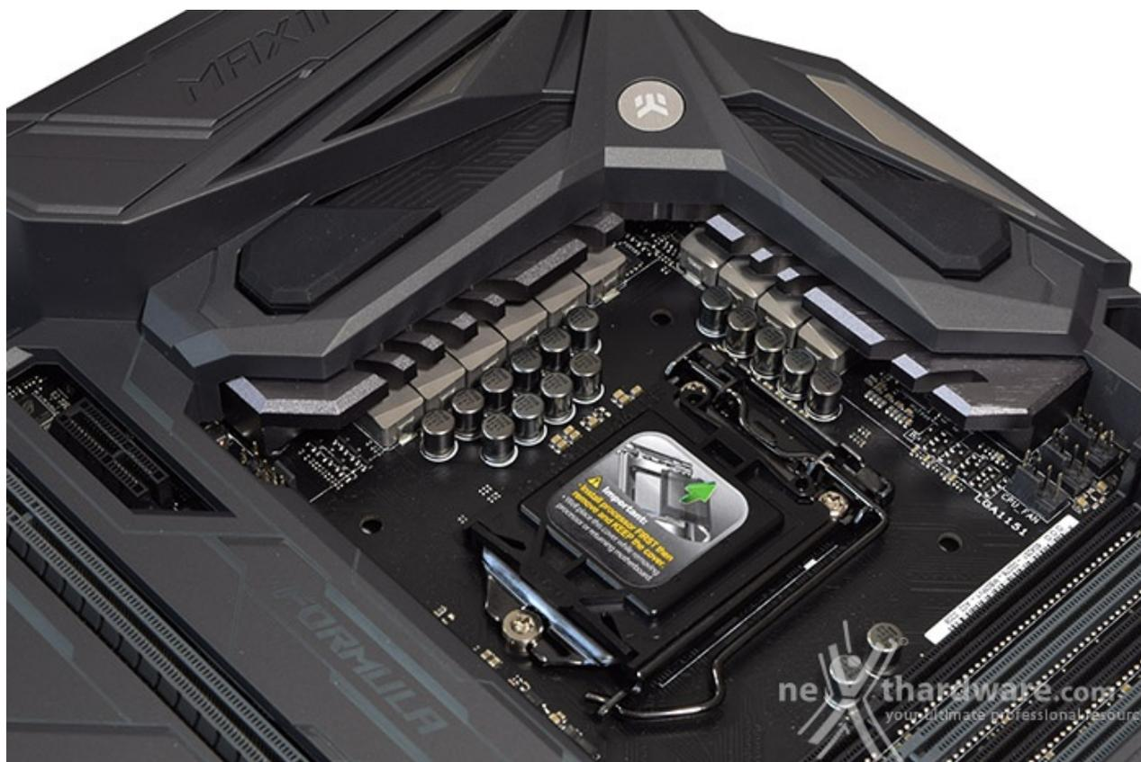
Il sistema di raffreddamento della ASUS MAXIMUS VIII FORMULA, denominato CrossChill e prodotto dalla slovena EK Water Blocks,↔ è formato da un unico elemento in rame in grado di scambiare più efficacemente il calore qualora venga utilizzato collegandolo ad un impianto a liquido ma, grazie al blocco esterno provvisto di alettatura, assicura una ottima efficienza anche nel più classico utilizzo passivo ad aria.
