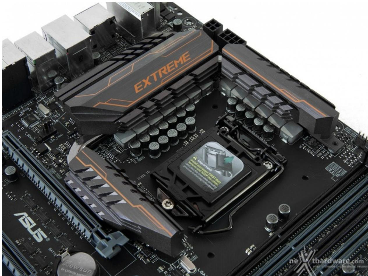
Il sistema di raffreddamento della ASUS MAXIMUS VIII EXTREME ASSEMBLY, progettato per assecondare la sua vocazione corsaiola, risulta suddiviso in due blocchi e prevede quattro dissipatori in alluminio, con serigrafie arancio di generose dimensioni, saldamente ancorati al PCB tramite backplate.
