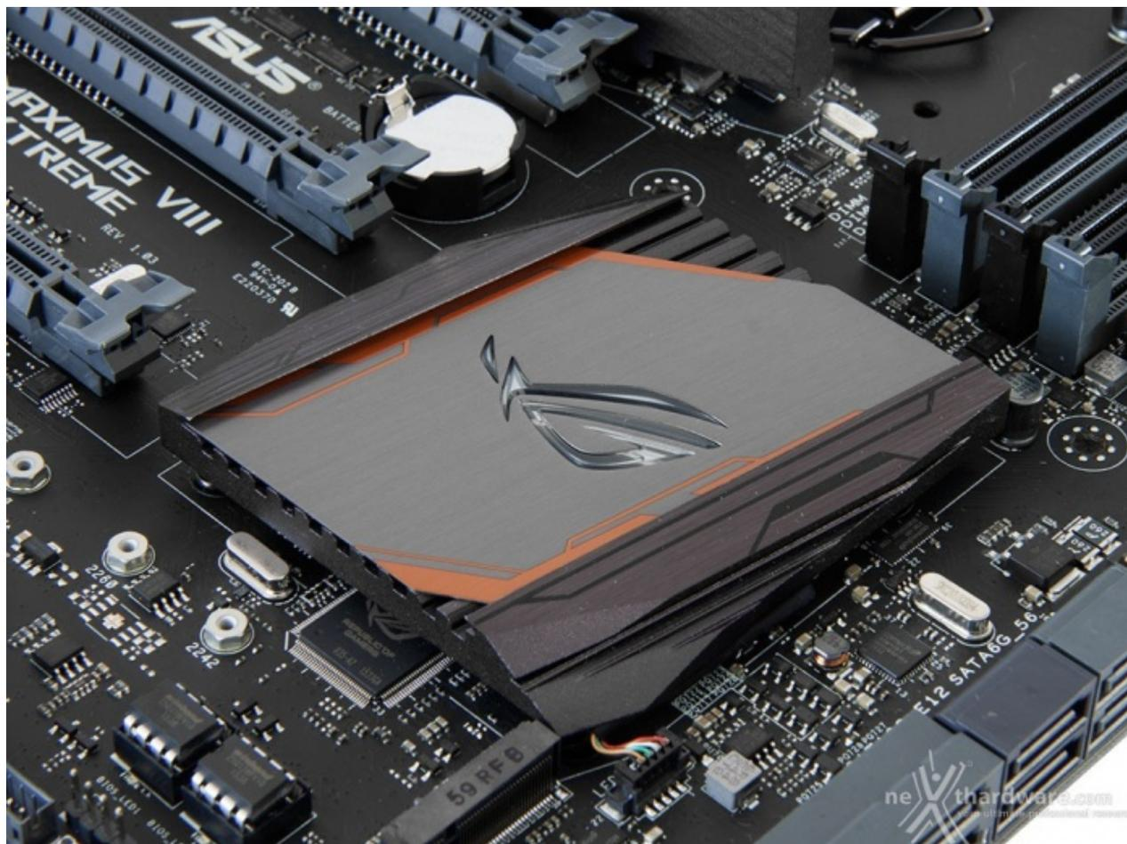
Il secondo blocco è invece costituito da un elemento a basso profilo con un buon numero di alette di piccole dimensioni, preposto al raffreddamento del PCH Z170.
