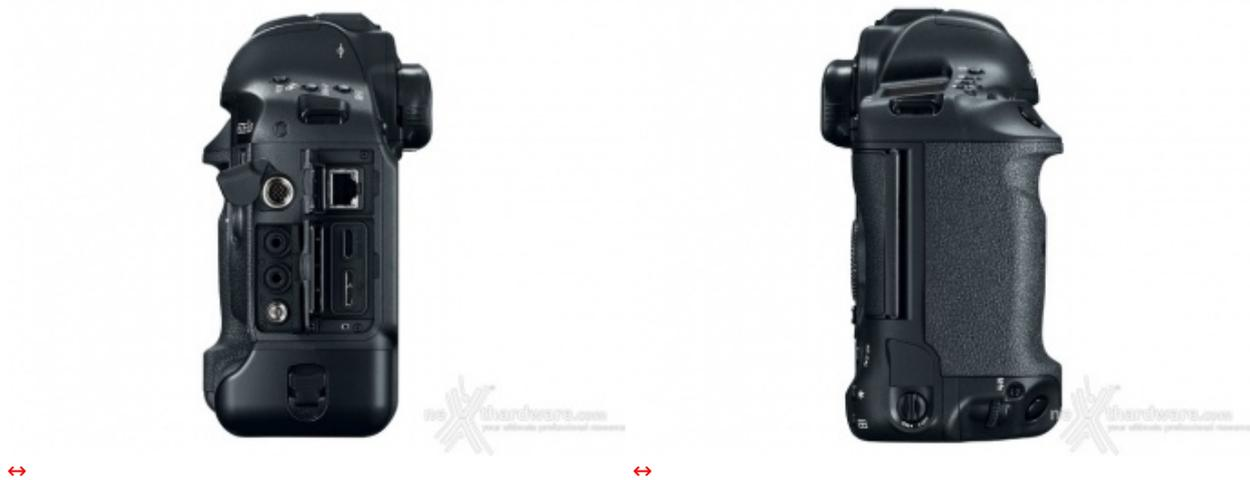
Le caratteristiche video sono al top: la **EOS 1D-X Mark II** può catturare video ad una risoluzione massima di **4096x2160px** (60p, 30p, 25p, 24p, 23.98p) e **1920x1080px** (120p, 60p, 50p, 25p, 24p, 23.98p), in formati **MPEG-4**, **H.264** e **Motion JPEG**↔ ma con audio mono; quest'ultimo è un problema risolvibile grazie all'ingresso per il collegamento di microfoni esterni.
