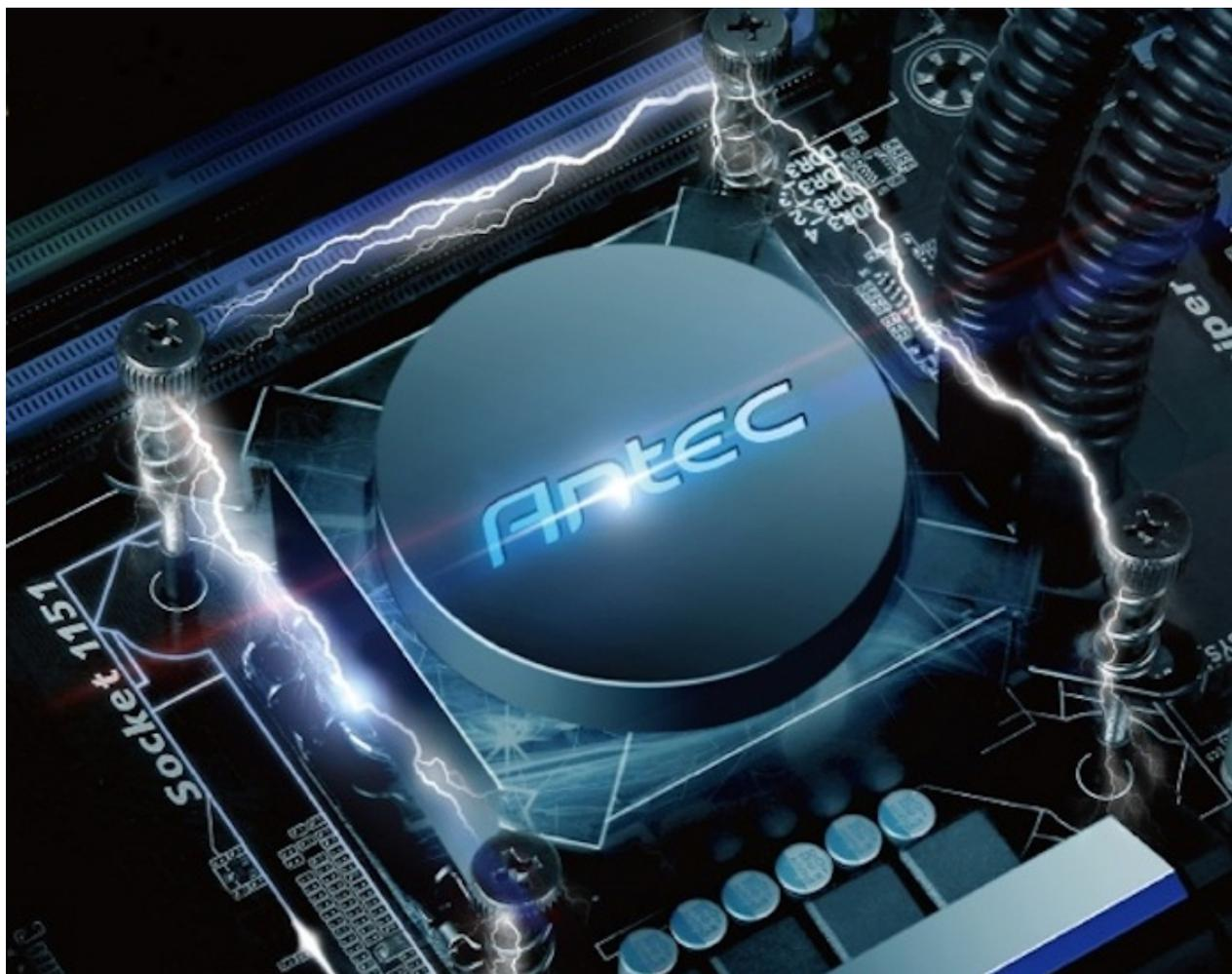
Le principali novità introdotte riguardano le ventole a LED blu da 120mm (di tipo PWM), capaci di ben 2.400 giri al minuto e dotate di cuscinetti in grafite senza bagno di olio con una durata sino a 150.000 ore, la pompa che vanta una bobina di tipo trifase con un'altissima velocità di rotazione della girante in grado di arrivare ad una prevalenza di ben 2,3m,↔ i radiatori con una fitta serie di alette da 0,28mm e, per finire, una grande base in rame per massimizzare il trasferimento del calore.
