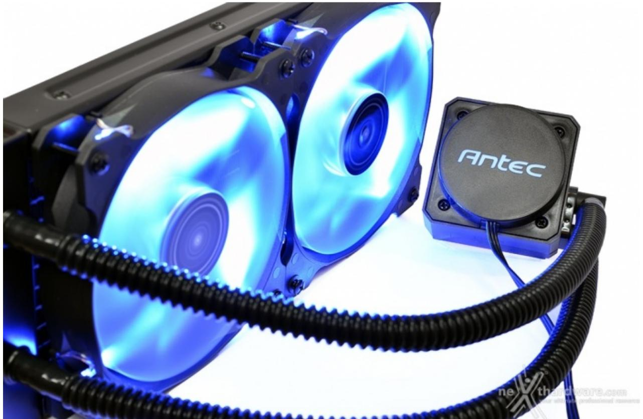
Ottime le ventole da 120mm fornite in bundle, che ricordiamo essere dotate di particolari cuscinetti in grafite senza bagno d'olio con un MTBF di ben 150.000 ore assicurando prestazioni di spessore e, al contempo, una rumorosità contenuta anche al massimo dei giri, regolabili a piacimento grazie alla tecnologia PWM (Pulse Width Modulation).
