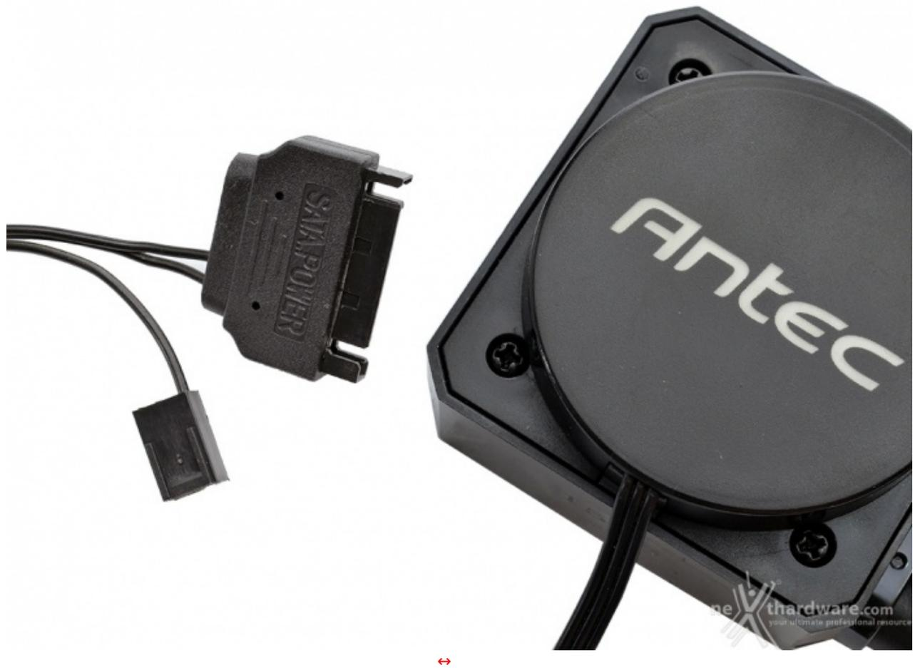
L'alimentazione della pompa è affidata ad un singolo connettore SATA Power che si occuperà di garantire i 12V necessari al corretto funzionamento della stessa e del LED posto sulla copertura.
