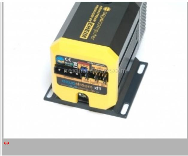
Il jumper in dotazione consente di attivare il programma di de-aerazione della pompa al fine di facilitare lo spurgo dell'impianto. Tale connettore ci consente inoltre di resettare i parametri della pompa se installato durante l'accensione della pompa.
