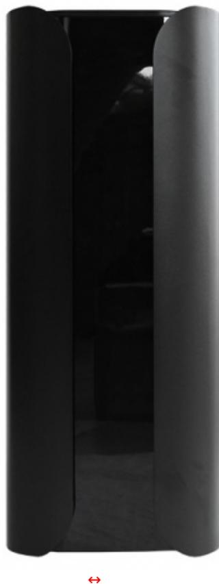
Come si può notare, la curvatura dei pannelli laterali in alluminio copre parte del frontale vero e proprio realizzato in plastica lucida.
