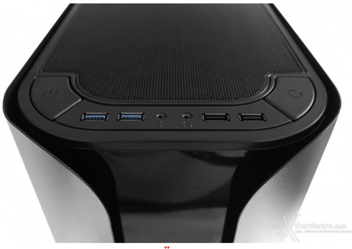
Continuando l'analisi del top del case troviamo, anteriormente, il pannello di I/O che consta di due porte USB 3.0, due connessioni HD Audio, due porte USB 2.0 ed i pulsanti di accensione e reset, dotati di LED di stato, posti alle rispettive estremità .
