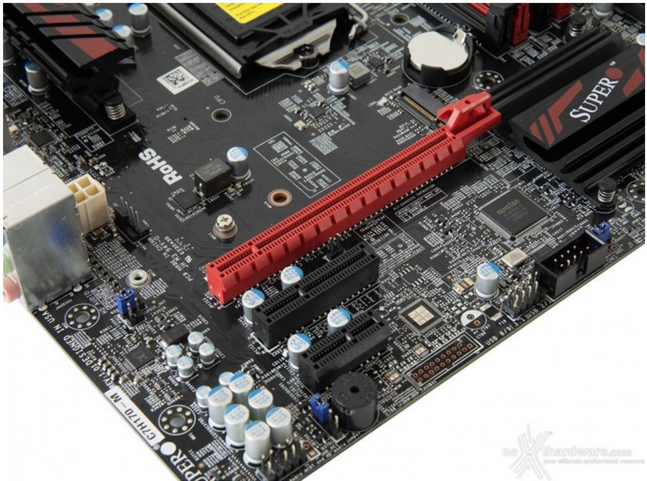
La dotazione di slot PCIe della Supermicro C7H170-M prevede un PCIe 3.0 x16, un PCIe 3.0 x4 ed un PCIe 3.0 x1.
