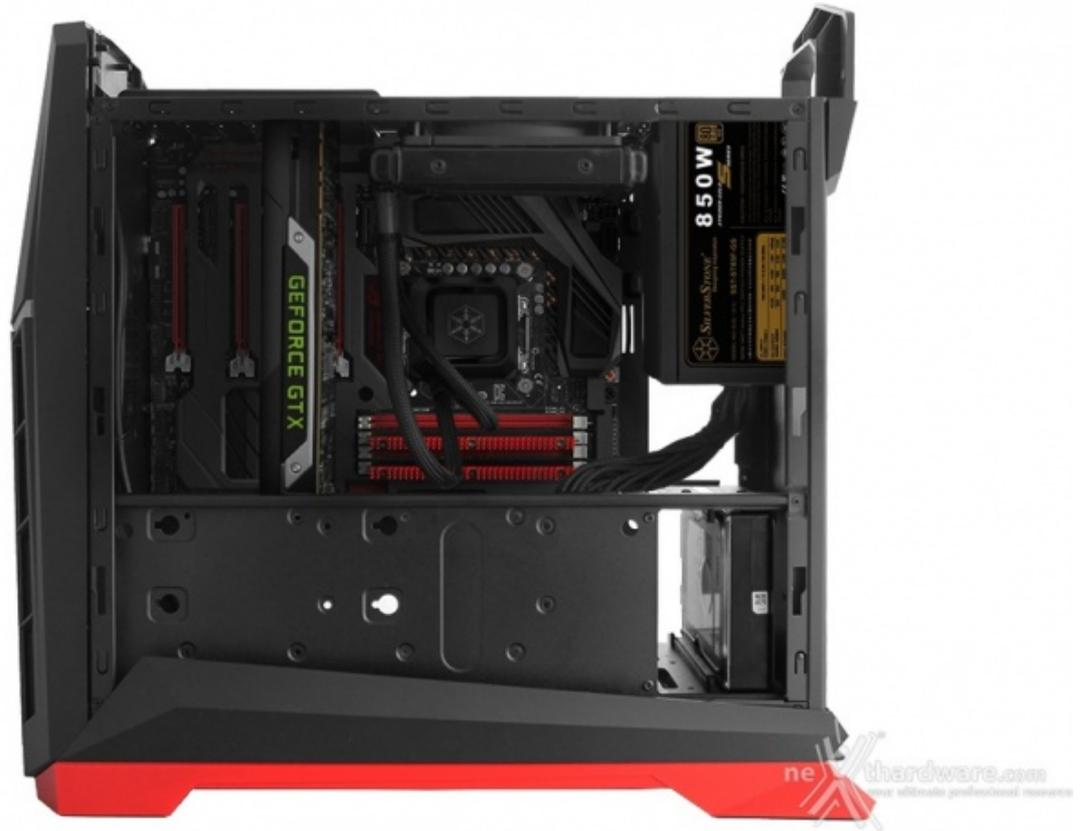
Per quanto riguarda il comparto video, l'operazione da eseguire è classica anche se le VGA dovranno seguire delle regole ferree, ovvero non superare i 125mm in larghezza qualora fossero più lunghe di 245mm, altrimenti si potrebbe avere qualche problema con i cavi d'alimentazione.
