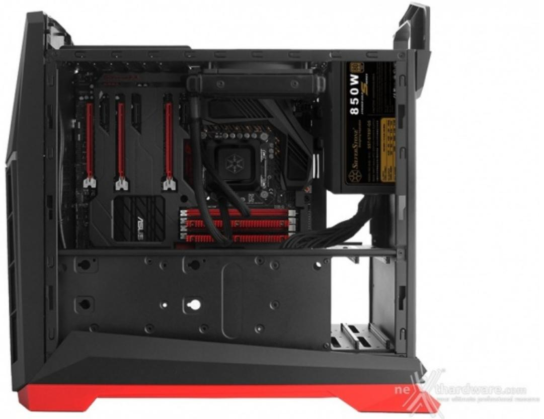
Il montaggio del sistema di raffreddamento a liquido con radiatore da 120mm è rapido e privo di ostacoli, soprattutto grazie all'ampia feritoia presente sul piatto mainboard, che permette di avere pieno accesso al sistema di ritenzione del blocco pompa/waterblock.
