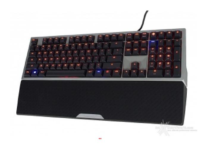
I tasti dotati di LED a due colori sono NUM LOCK, MAIUSC, SCROLL LOCK, WIN e FN.
