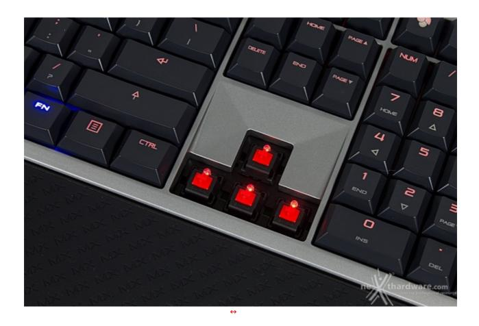
Questo elevatissimo grado di regolazione ci permette, tra le altre cose, di riprendere il dettaglio degli switch integrati, gli MX Red lineari da 45cN.
