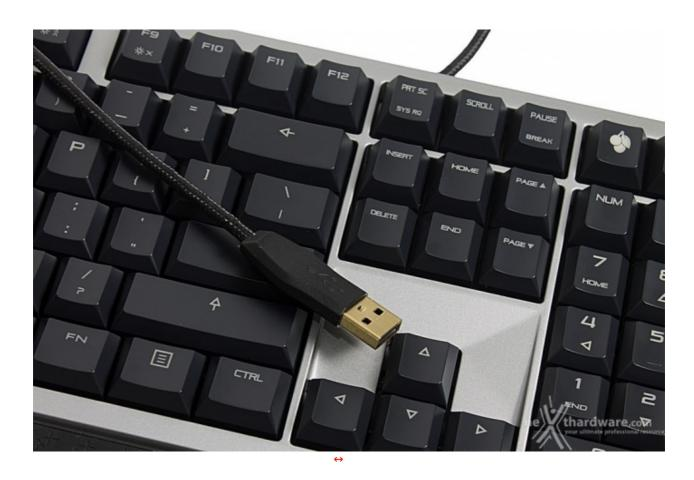
Ultimo dettaglio costruttivo rimasto è il cablaggio, che presenta un eccellente rivestimento cordato e sfoggia un connettore USB con placcatura oro per una migliore resistenza contro gli agenti ossidanti.
