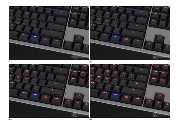
Particolarmente interessante, poi, è il sistema di gestione dell'illuminazione che garantisce un inaspettato livello di regolazione in 100 step differenti.
