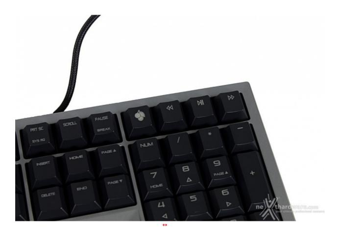
L'unica estensione al layout, altrimenti perfettamente standard, sono i tasti dedicati alle funzionalità multimediali ricavati sul margine della tastiera e supportati anch'essi da switch meccanici.
