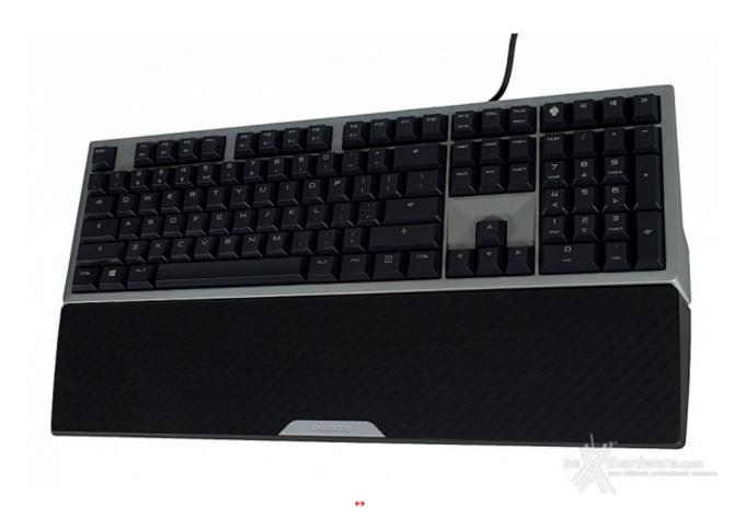
Il primo impatto con la qualità costruttiva ci viene offerto dallo chassis frontale in puro alluminio, che copre l'intera struttura della tastiera, realizzata anche con l'uso di plastica.
