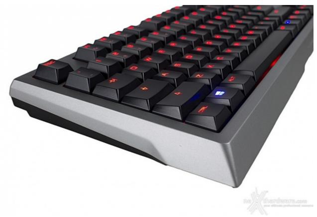
I keycaps utilizzati sono di profilo leggermente ribassato (due millimetri rispetto ai keycaps MX full-height contoured), consentendo ai designer di ottenere un altezza minore a fini prettamente estetici.
