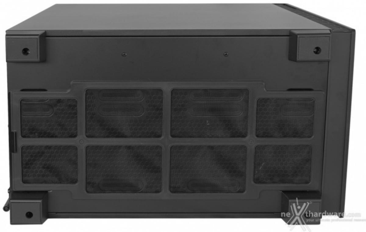
Il fondo del Carbide 600C è molto semplice: quattro grandi piedini in plastica permetteranno alla griglia, che percorre l'intera parte bassa del telaio, di lasciar passare abbastanza aria da destinare alla componentistica hardware.
