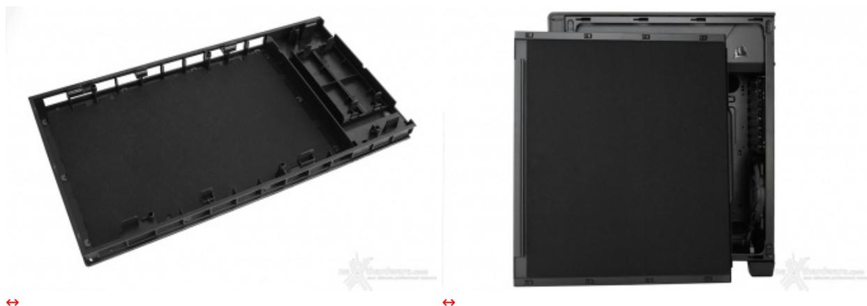
Internamente, il case è quasi completamente insonorizzato grazie a dei pannelli fonoassorbenti disposti sul coperchio in plastica del frontale, nella parte alta del telaio e su entrambe le paratie.
