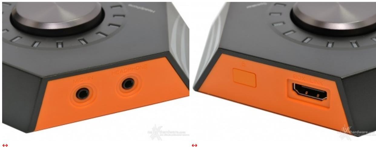
Il controller ospita due connettori da 3,5mm per collegare comodamente all'occorrenza il nostro headset analogico.↔
