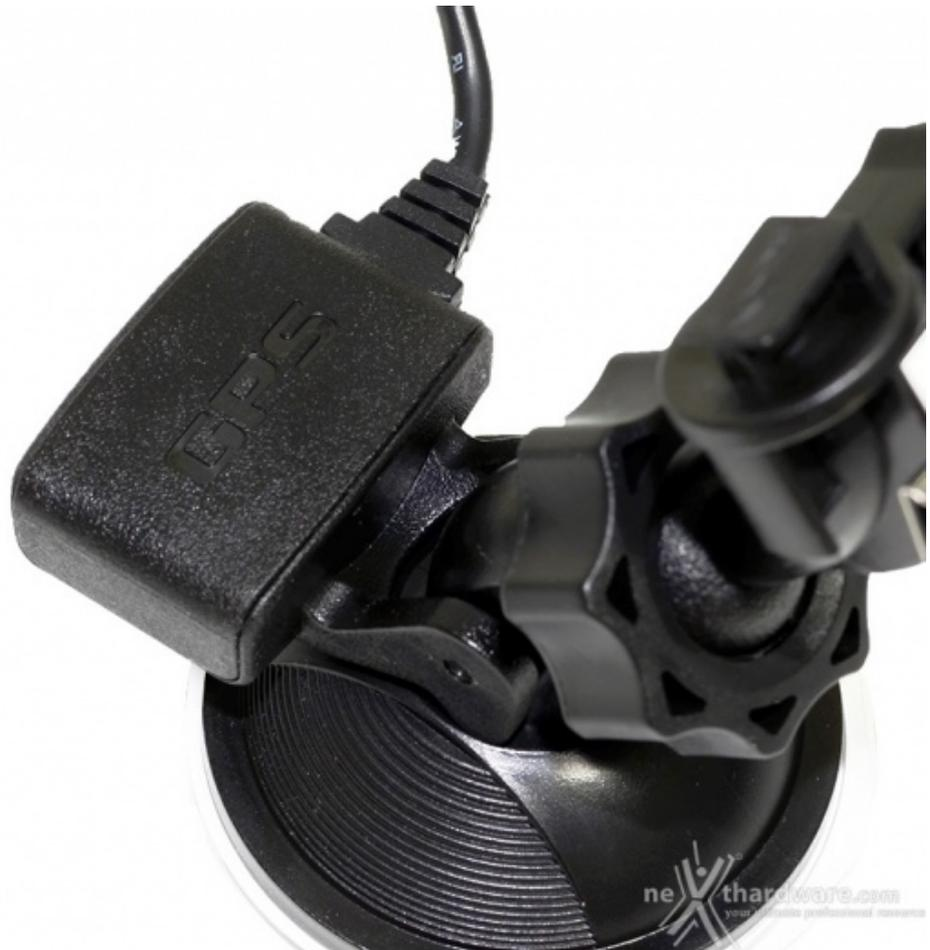
Simpatica la duplice funzione del GPS che costituisce un corpo unico con il meccanismo di blocco della ventosa, diventando di fatto una levetta.
