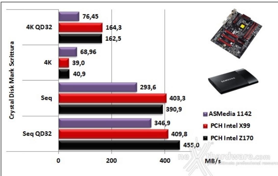
Nella prova in scrittura non ci sono grandi cambiamenti tranne che per il sorprendente risultato positivo ottenuto dal controller ASMedia ASM1142 utilizzando il file da 4kB, malgrado continui ad accusare un elevato gap con gli altri pattern.
