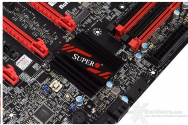
I dissipatori in alluminio impiegati sulla Supermicro C7Z170-SQ risultano ben dimensionati ed offrono un design aggressivo ed estremamente efficace ai fini della funzionalità per la quale sono stati progettati.
