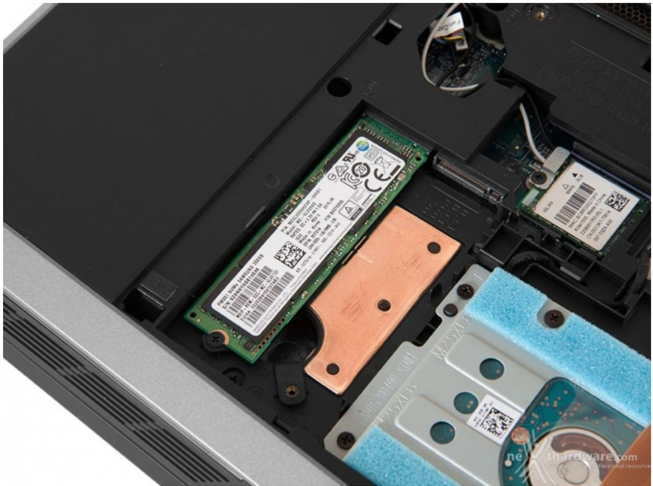
Come potete osservare, l'unità in prova prevede la presenza come disco di sistema di un unità SSD Samsung PM951 NVMe, in grado di assicurare prestazioni velocistiche degne di nota in virtù dell'utilizzo del nuovo protocollo di comunicazione che va ad eliminare i colli di bottiglia tipici dell'ormai obsoleto AHCI.
