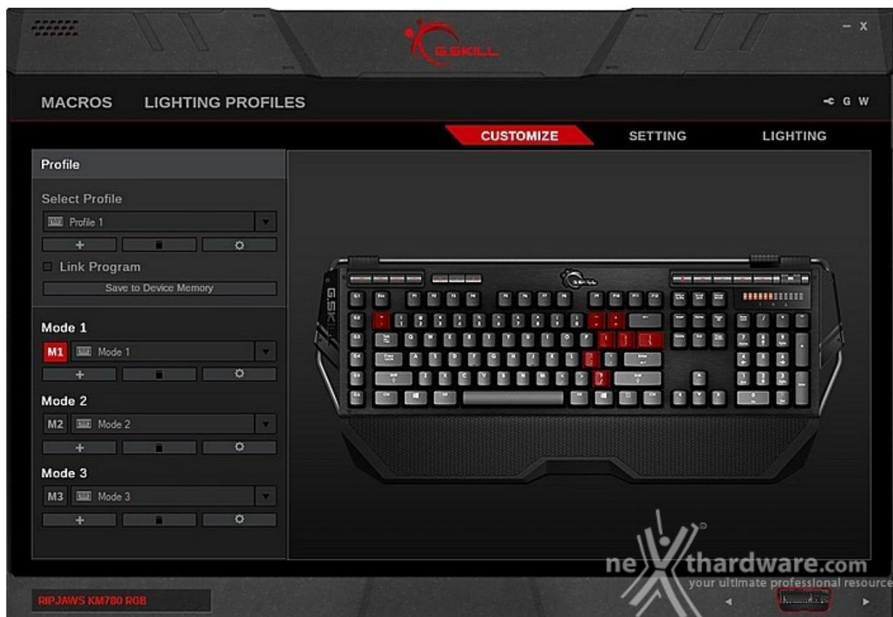
La prima tab permette la riprogrammazione dei tasti e ci permette la gestione dei setup.
