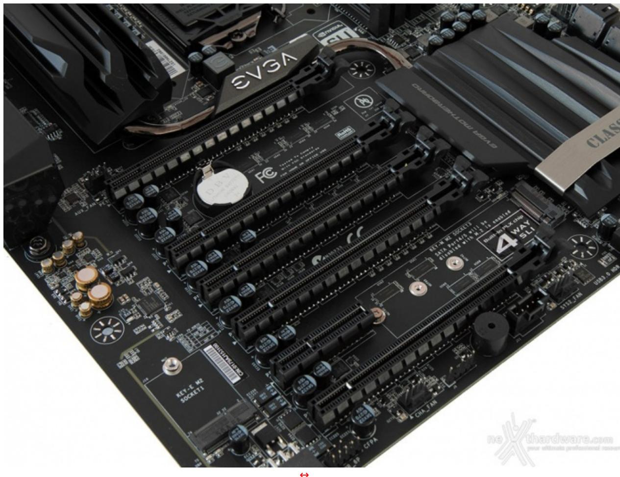
In alto possiamo osservare la ricca dotazione di slot PCIe della EVGA Z170 Classified 4-Way, comprendente cinque x16 3.0, in grado di accogliere fino a quattro VGA, ed uno slot x4 3.0.
