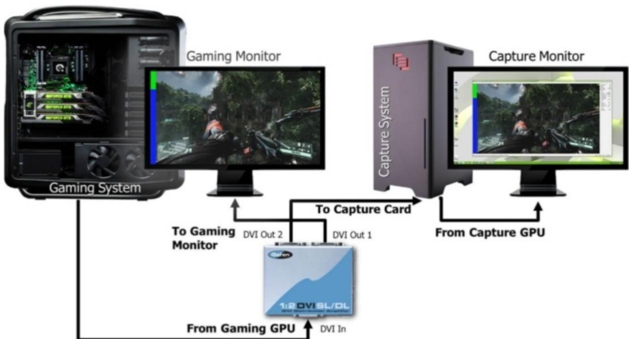
Per utilizzare FCAT è necessario dotarsi di due PC: il primo è la macchina di test dove vengono eseguiti i benchmark ed i videogiochi, mentre il secondo si occupa di acquisire il flusso video prodotto dalla scheda video in prova e di registrarlo per una successiva analisi.
