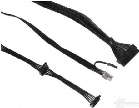
Lo sleeving è completamente assente, fatta eccezione per il cavo ATX. Sebbene l'uso di un cablaggio di tipo piatto risulti comunque gradevole e garantisca una maggiore flessibilità, avremmo preferito una soluzione vecchia maniera almeno per quanto riguarda i cavi di potenza, quali EPS e PCI-E.
