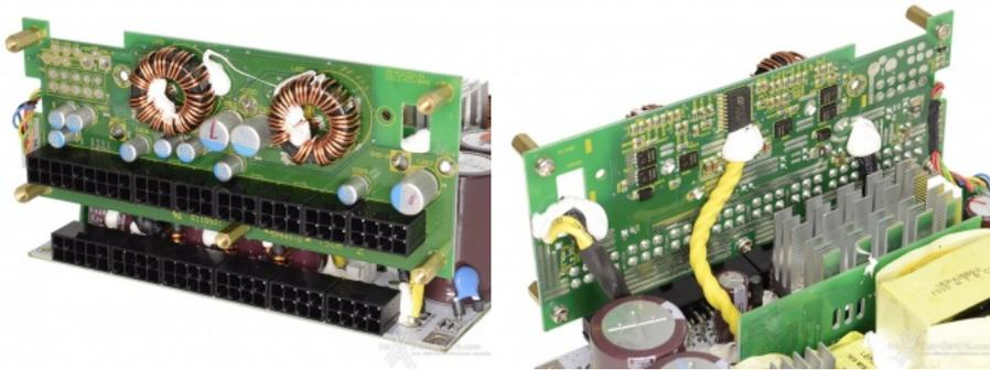
Quelli utilizzati per carichi importanti derivano direttamente dal PCB principale, riducendo in questo modo le cadute ohmiche ed evitando l'impiego di conduttori esterni, più lunghi e con una sezione inferiore.
