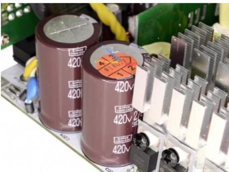
Condensatori Nippon Chemi-Con [KMR](http://www.chemi-con.co.jp/e/catalog/pdf/al-e/al-sepa-e/001-guide/al-seriestable-e-140101.pdf) (<http://www.chemi-con.co.jp/e/catalog/pdf/al-e/al-sepa-e/001-guide/al-seriestable-e-140101.pdf>).
