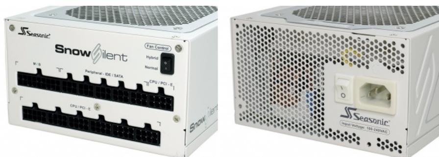
La parte frontale dello Snow Silent 750W, impreziosita da pregevoli serigrafie, ospita le connessioni modulari disposte su due file e l'interruttore per la selezione della modalità di funzionamento della ventola.
