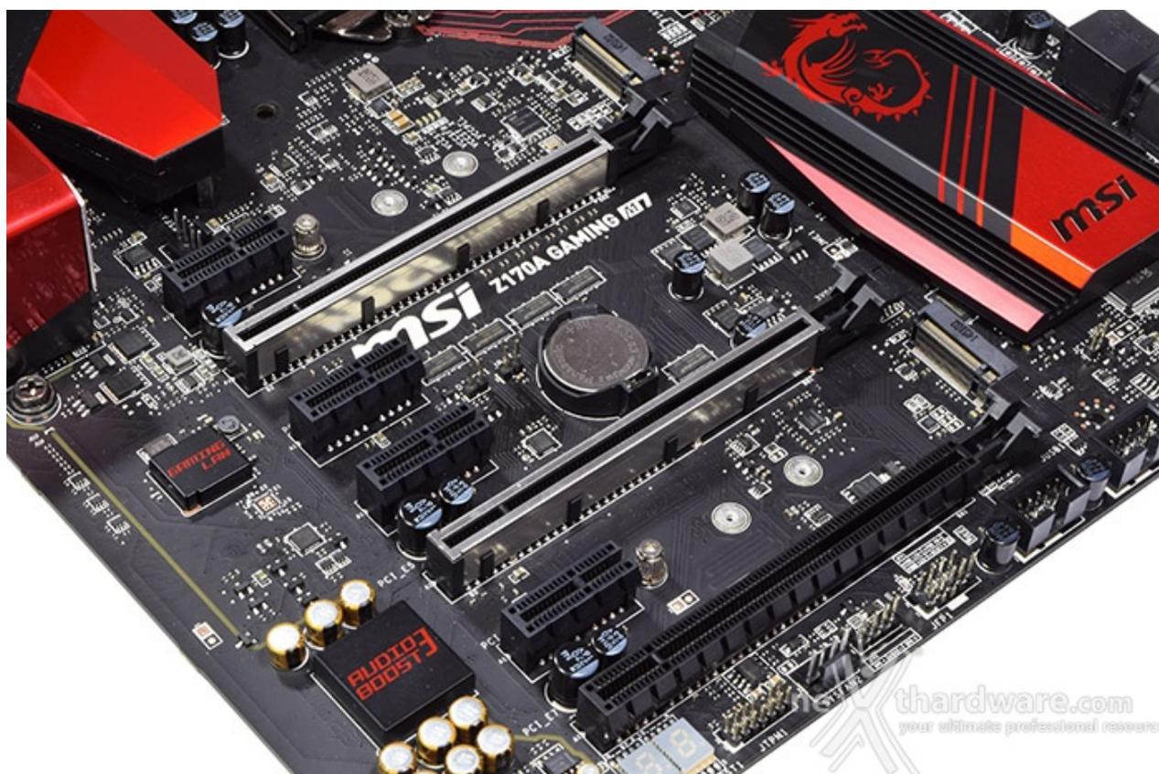
I primi due slot 16x sono ben distanziati tra loro in maniera tale da permettere una agevole installazione di due VGA a doppio slot, adottando inoltre, per la prima volta, la tecnologia Steel Armor che consta di un guscio metallico posto a rinforzo degli stessi, direttamente saldato al PCB.
