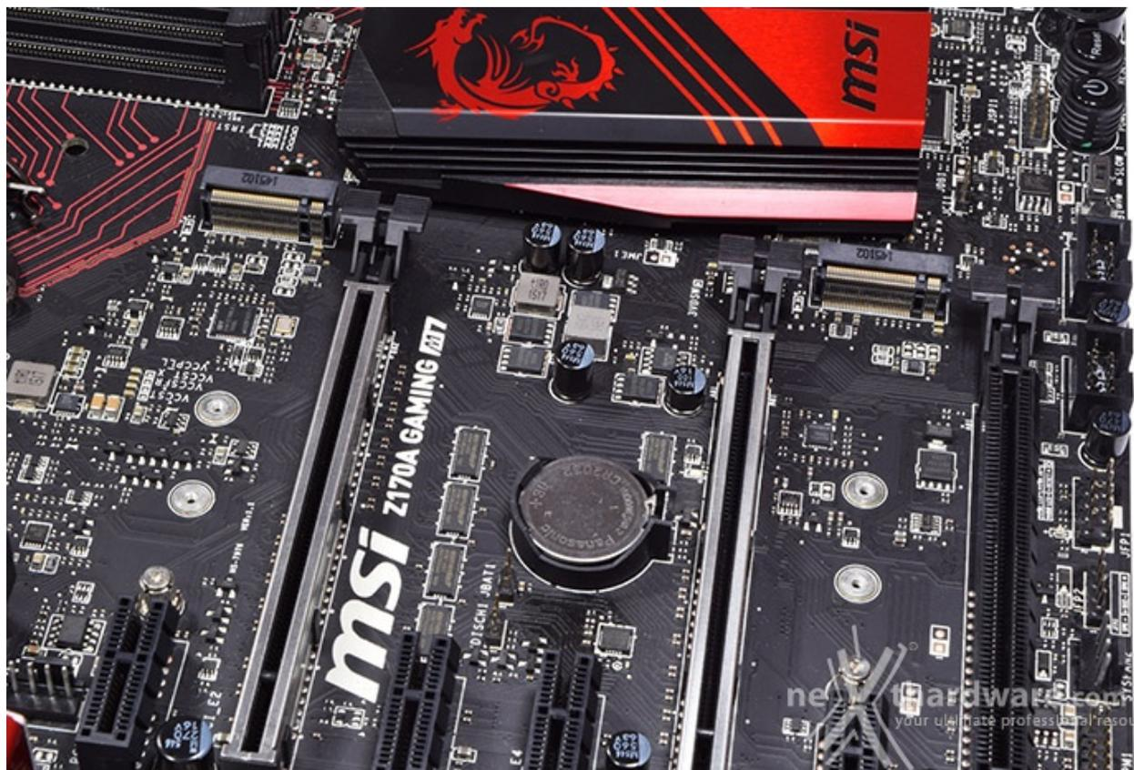
La MSI Z170A GAMING M7 offre due connettori M.2 PCIe in grado di ospitare altrettanti SSD PCIe 3.0 x4 o SATA 6Gb/s.
