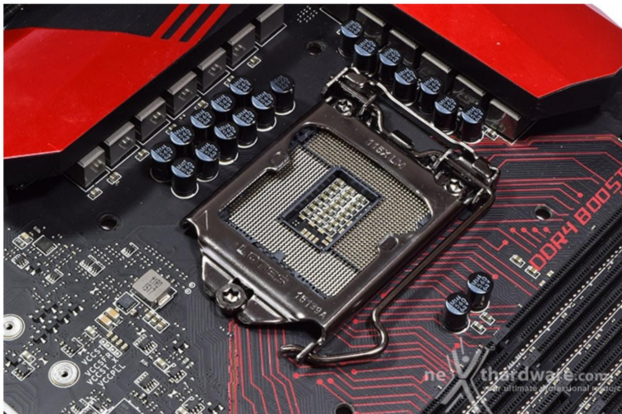
Il socket utilizzato è il nuovo Intel LGA 1151, progettato per garantire la piena compatibilità con i nuovi processori Skylake, ma non compatibile con gli Intel Core di precedente generazione.
