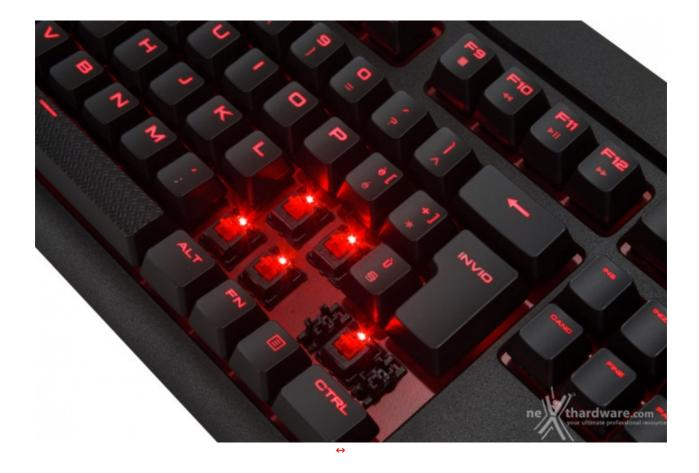
Rimuovendo i keycaps con l'ausilio dell'ottimo estrattore visto precedentemente, mettiamo a nudo gli switch Cherry serie MX Red.
