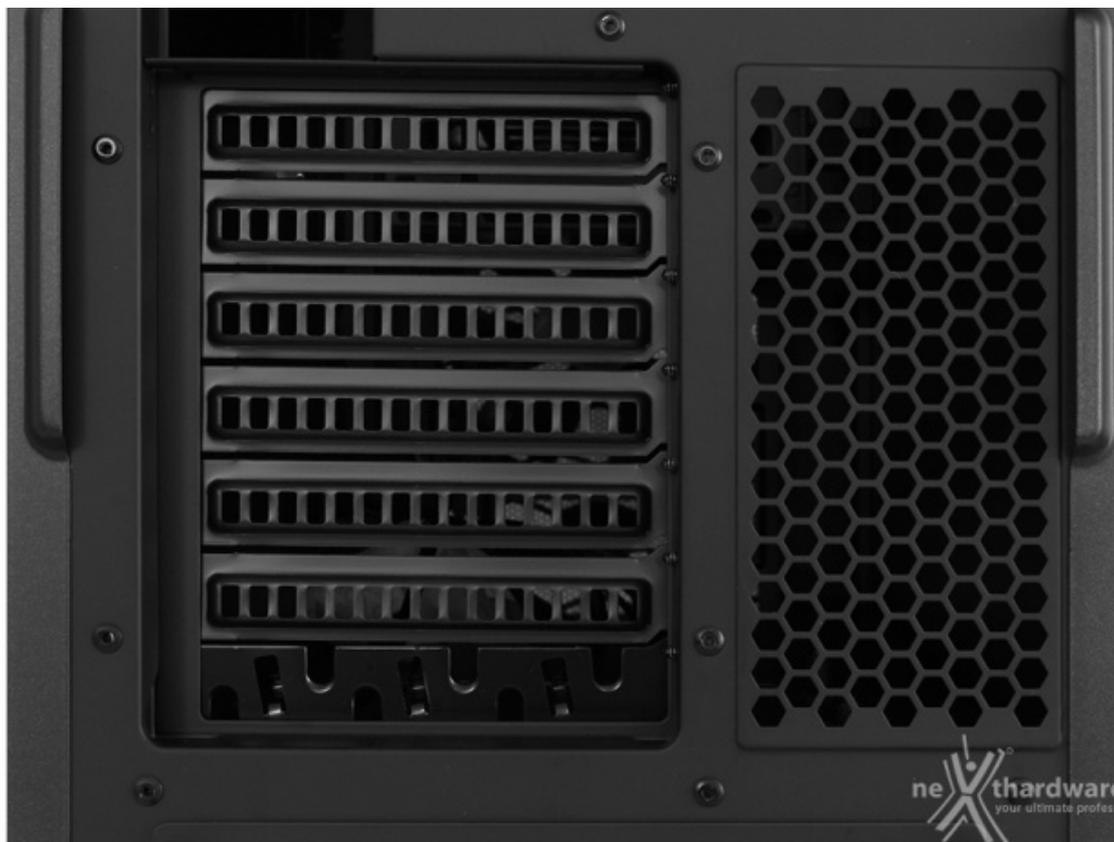
Poco più in basso vi sono sette coprislot, di cui sei dotati di feritoie ed uno, posizionato come ultimo, dotato di fori specifici per il passaggio di cavi dall'interno all'esterno (o viceversa), alla cui destra è presente una griglia a fori esagonali.
