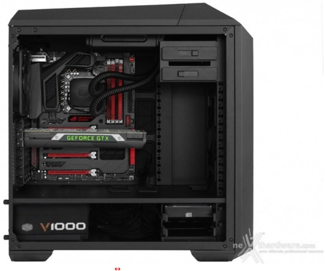
Per inserire l'alimentatore all'interno dell'apposito vano è necessario rimuovere il bezel e fissarlo sull'alimentatore stesso, bloccando poi il tutto al telaio del case.
