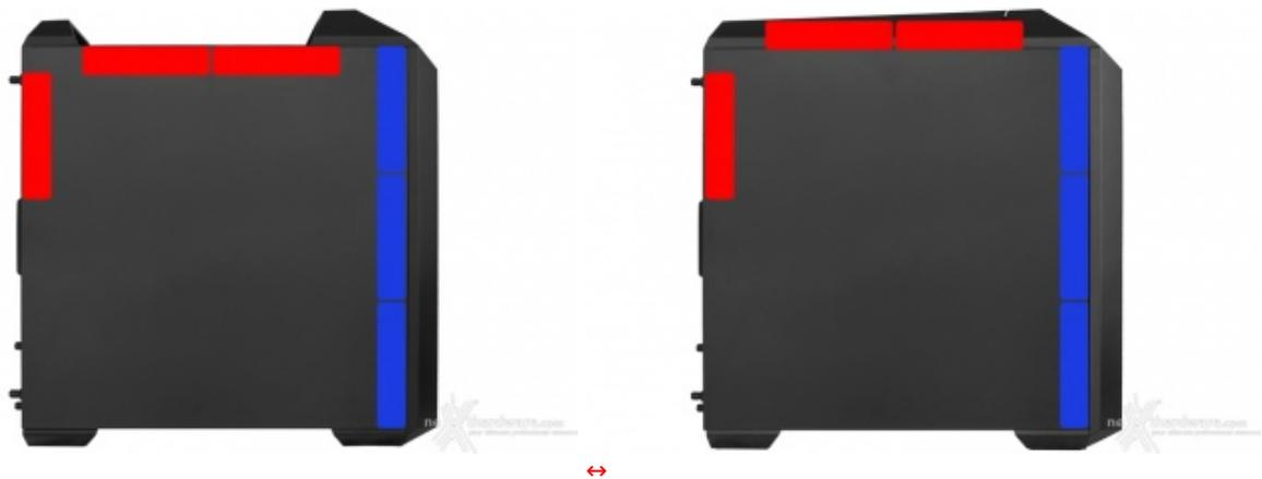
In aggiunta a quelle già presenti sarà possibile dotare il frontale di una terza ventola da 140mm e il top di altre due unità da 120/140mm.
