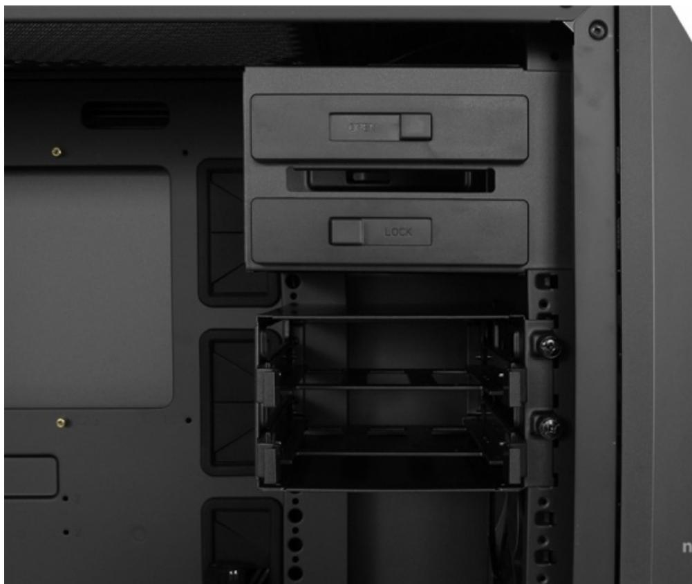
Entrambi i supporti sono removibili, ma solo quello per drive da 3,5" permette di essere regolato in altezza. Lungo tutto il bordo anteriore e sul lato del vano mainboard, infatti, sono presenti una serie di fori sui quali il suddetto cestello può essere fermato in base alle proprie esigenze.
