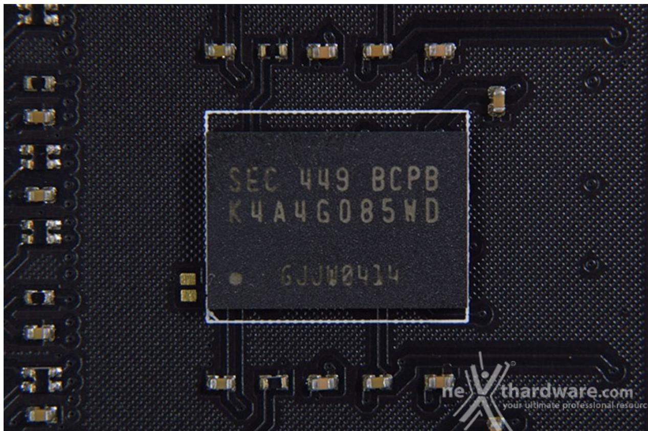
Le Corsair Vengeance DDR4 LPX 3200MHz utilizzano ICs **K4A4G085WD** di produzione Samsung, progettati per operare con una tensione nominale di 1,2V ma, come vedremo più avanti, in grado di accettare senza problemi tensioni fino a 1,55V, permettendo di ottenere un buon incremento della frequenza operativa ed un'impostazione molto più aggressiva dei timings.
