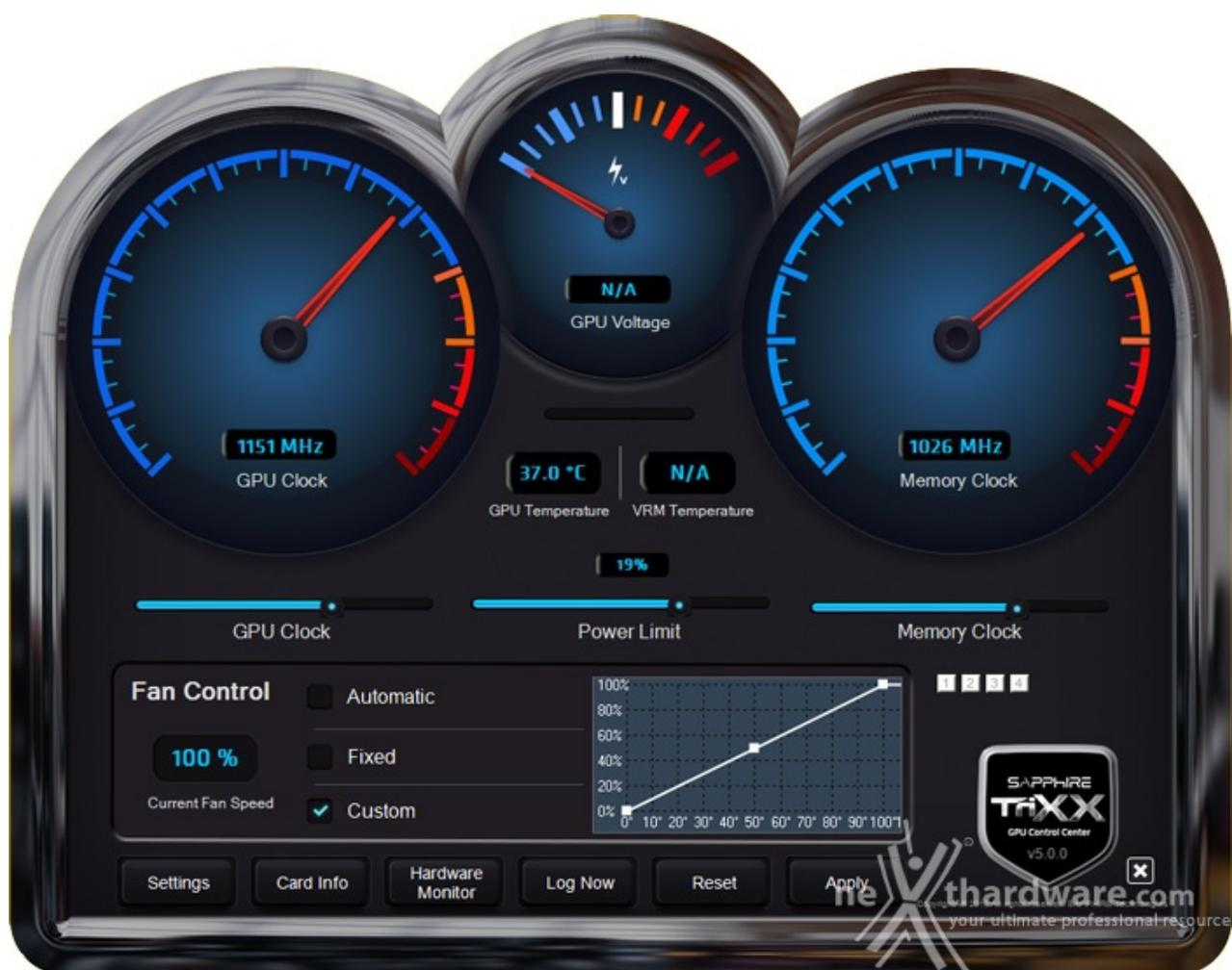
Per valutare le frequenze massime raggiungibili dalla SAPPHIRE Radeon R9 Fury Tri-X OC ci siamo avvalsi dell'utility TRIXX di SAPPHIRE in versione 5.00, sia per modificare la velocità di clock di base che i parametri di assorbimento energetico.
