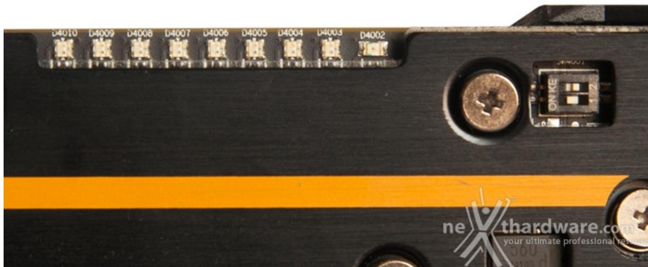
In questa immagine si notano gli 8+1 LED, chiamati GPU Tach LED dal marketing AMD, che indicano il livello di intensità di utilizzo della GPU e il dip switch per la loro configurazione
