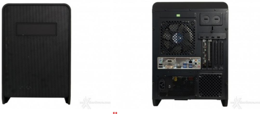
Il frontale è caratterizzato da un'ampia mesh metallica dove spicca il vano da 5,25" per l'inserimento di un'eventuale unità ottica, mentre il lato posteriore vede, dall'alto verso il basso, una griglia da 120mm per la ventola in estrazione, il vano per l'I/O Shield della scheda madre affiancato da quattro slot PCI e, da ultimo, l'alimentatore spostato verso sinistra con, alla sua destra, un'ulteriore sezione forata da 80mm.
