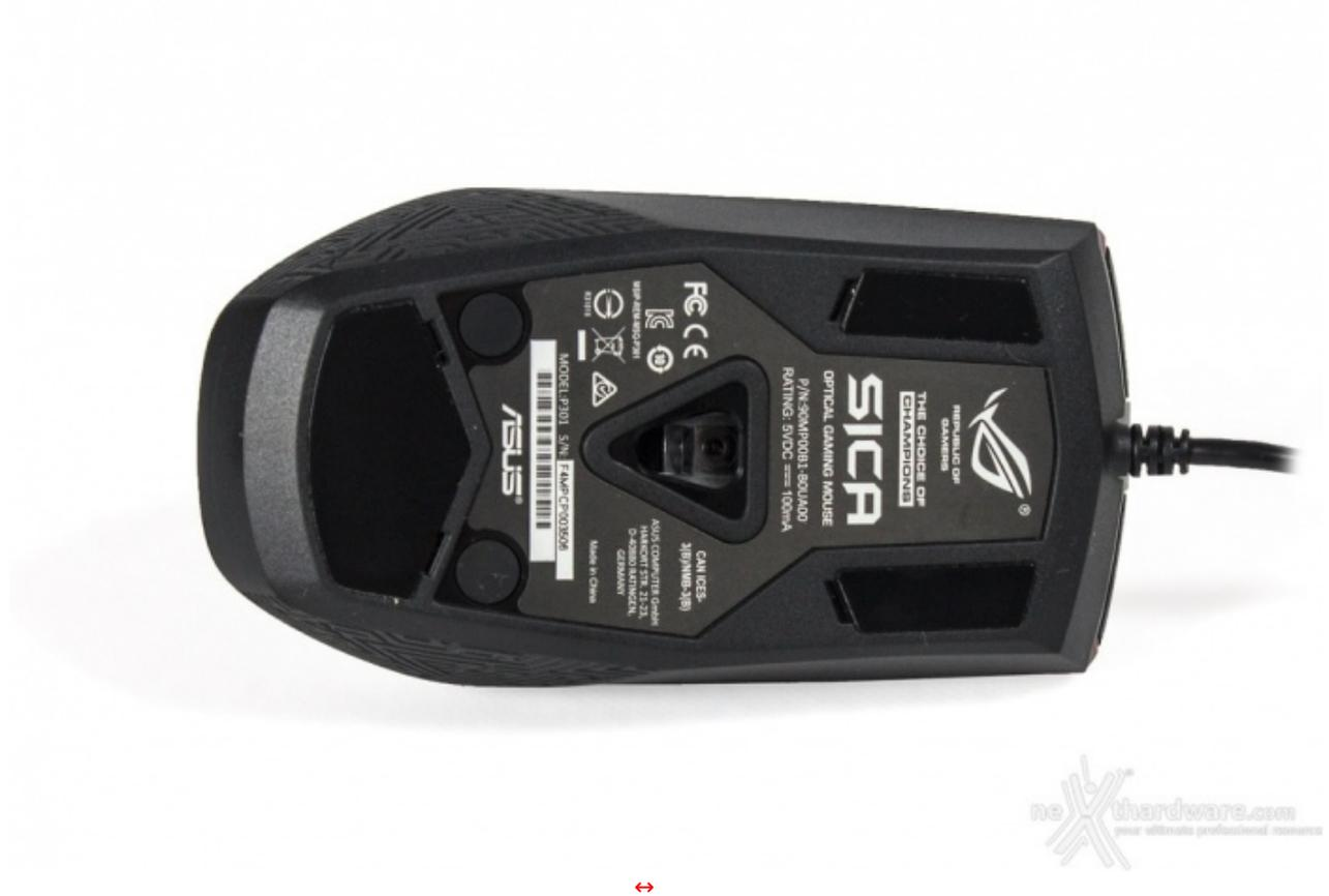
Analizzando la base, oltre al sensore ottico PixArt PMW 3310 posizionato centralmente, troviamo una disposizione molto stabile di tre padsurfer in teflon con degli incavi per permettere una facile sostituzione degli stessi.
