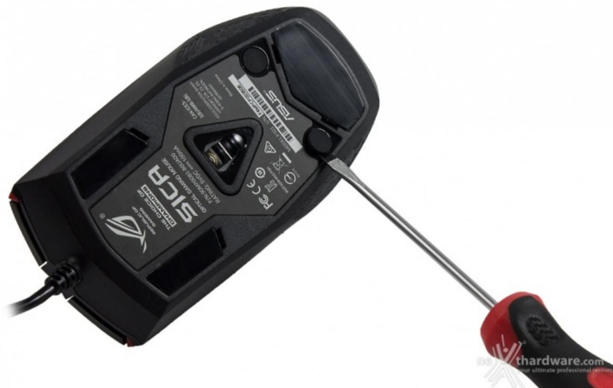
Torniamo un momento sulla base del ROG Sica per introdurre una caratteristica molto interessante, ovvero la possibilità di aprirlo, senza rimuovere i pad surfer, per procedere alla sostituzione dei microswitch dei pulsanti principali.
