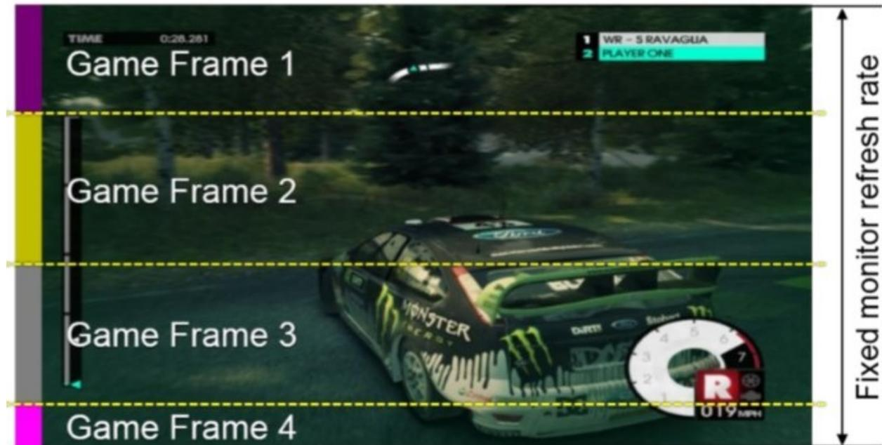
Sulla macchina di test è necessario eseguire, in contemporanea al test scelto, un piccolo software che va a disegnare su ogni frame una banda di colore differente.↔
