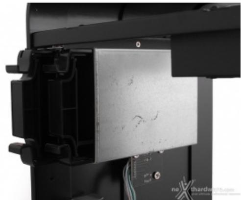
Lungo il pannello anteriore, oltre al piccolo PCB del pulsante d'accensione e del LED di stato, vi è un secondo cestello per due drive da 2,5" ed i ganci per il fissaggio dell'alimentatore SFX o SFX-L.
