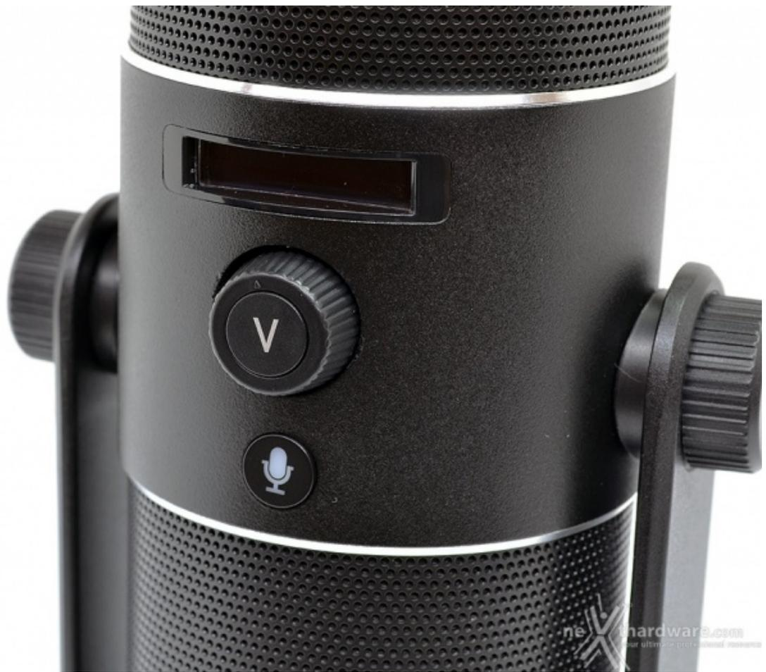
Il retro del microfono accoglie invece il display OLED che ci mostrerà in tempo reale il modello polare selezionato, il gain del microfono ed il volume in uscita delle cuffie.
