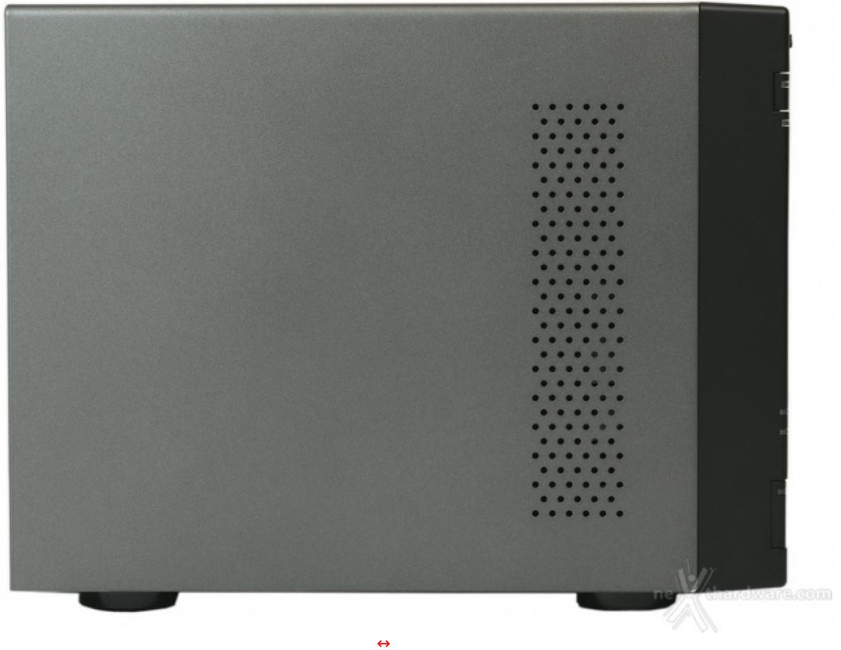
La vista laterale non mostra elementi distintivi, se non la griglia di aerazione che favorisce l'immissione dell'aria in prossimità dell'elettronica di controllo.
