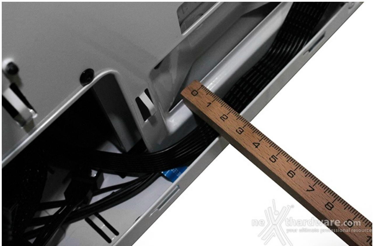
I 22mm di spazio che intercorrono tra il piatto mainboard ed il pannello di destra, nonché il vano alimentatore coperto dalla relativa cover, ci hanno consentito di canalizzare perfettamente i cavi ed occultare quelli in eccesso con estrema facilità ed ordine.
