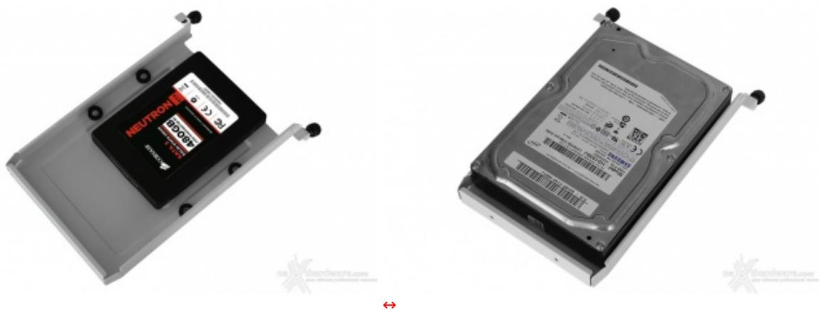
Per quanto riguarda le unità di storage, la predisposizione per due SSD presente sulla cover dell'alimentatore, pur essendo molto bella da vedere, risulta piuttosto scomoda per il cablaggio, motivo per cui abbiamo utilizzato i classici supporti utilizzabili anche per drive da 3,5".
