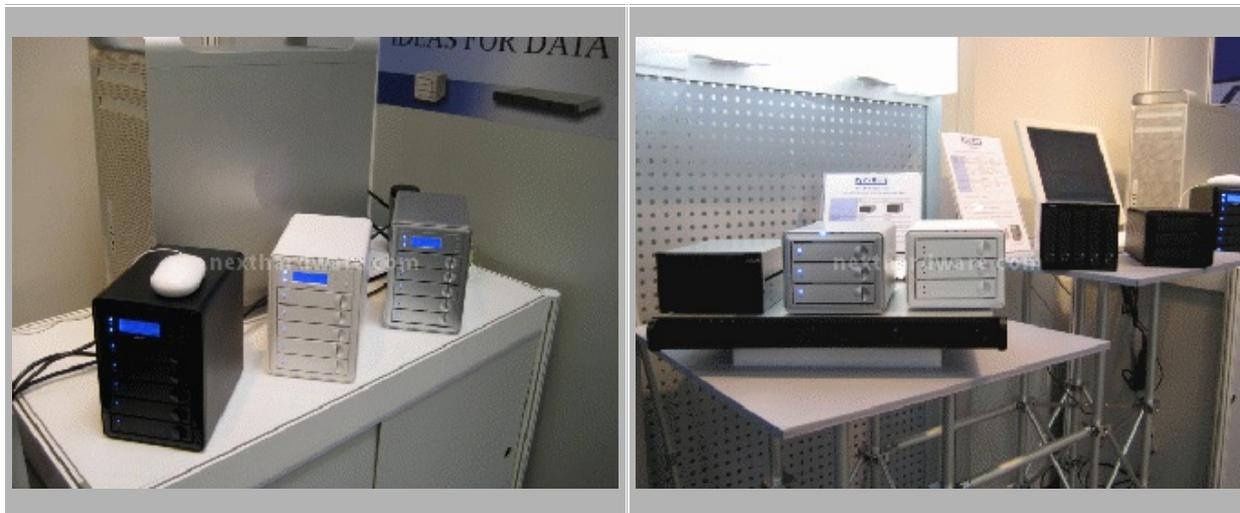
FIT integra un controller RAID in grado di gestire i livelli 0, 1, 3, 5, PM, Large e Clone. La funzionalità di on-line re building permette di sostituire a caldo in un Raid 5 un disco guasto senza la necessità di spegnere FIT.
