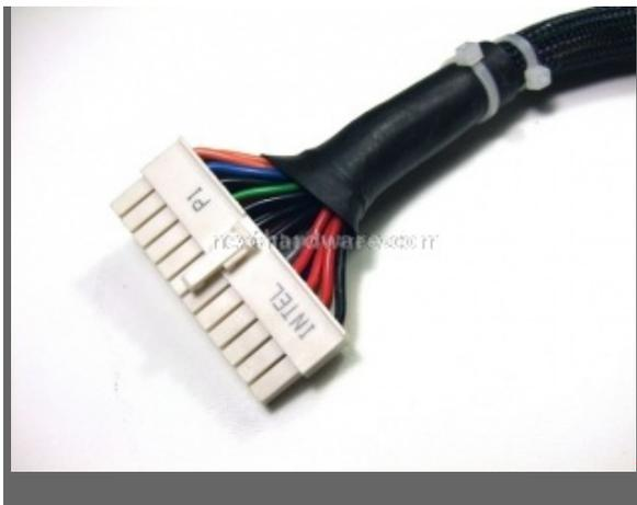
Cavo di alimentazione ATX 24pin
