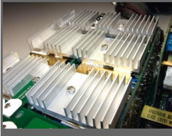
Tutti i componenti che necessitano di dissipazione sono montati su basi in ottone che funzionano come Heatpipe, trasportando il calore nella sezione superiore dove vengono accoppiate a tradizionali dissipatori di alluminio.
