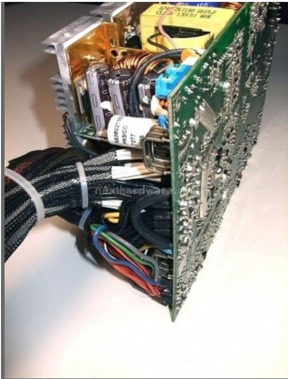
Lato connessioni in uscita: particolare curioso la scelta di utilizzare cavi di colore bianco per identificare le linee a +12volt.
