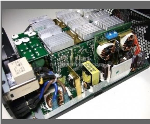
Anche se ogni centimetro utile è stato occupato rendendo difficile vedere con chiarezza la disposizione dei componenti, è impossibile non notare i due alimentatori da 50ampere montati in
