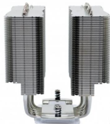
La particolare struttura dalle dimensioni di 160x150x135mm presenta un vero e proprio "taglio" delle alette esterne inferiori, ovviando in questo modo ai limiti strutturali che rendevano il vecchio modello NH-D14 incompatibile con i moduli di RAM ad alto profilo.
