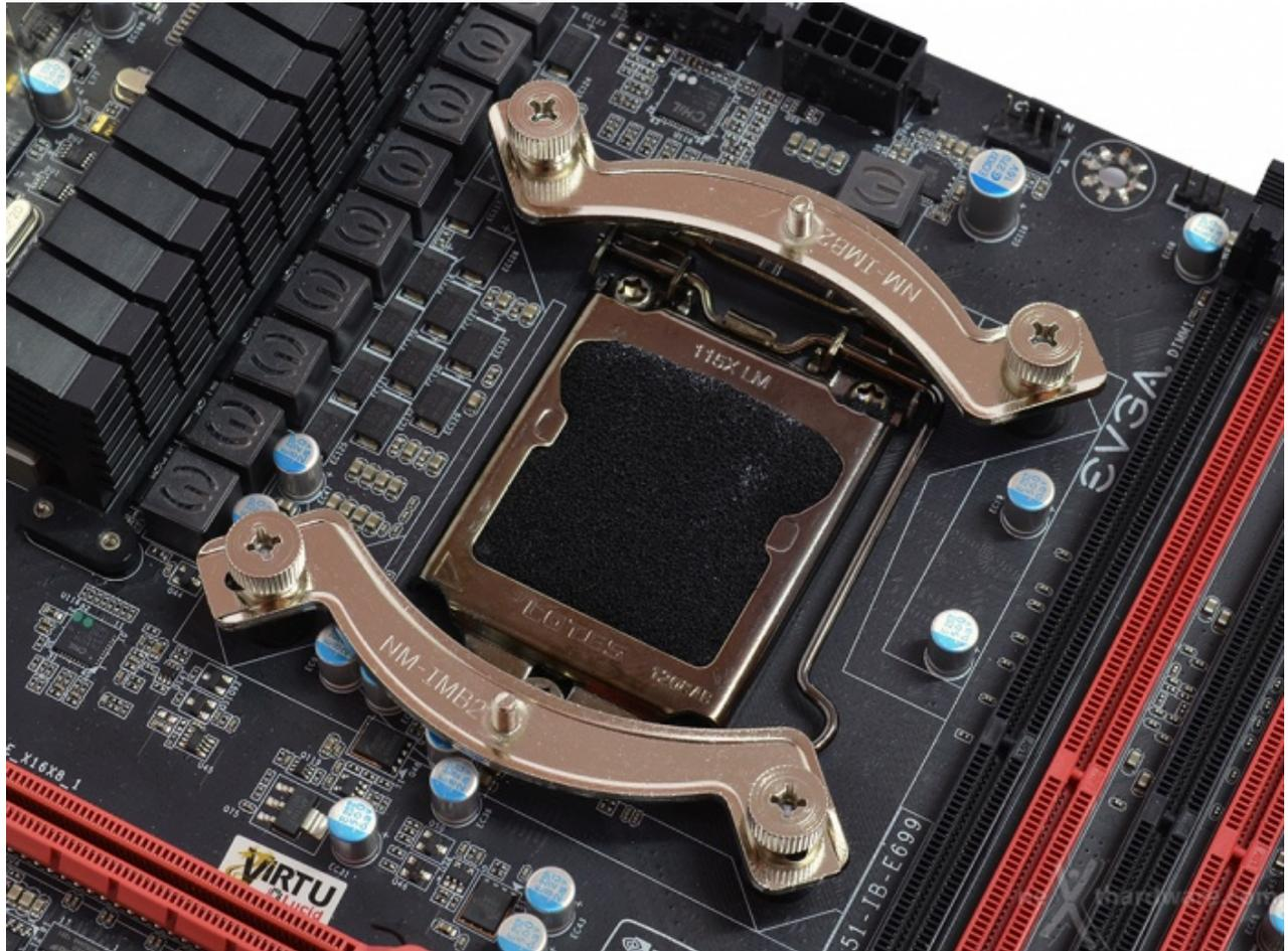
Una volta serrate le staffe al backplate grazie alle quattro viti con testa zigrinata, non resta che andare ad installare il corpo dissipante.
