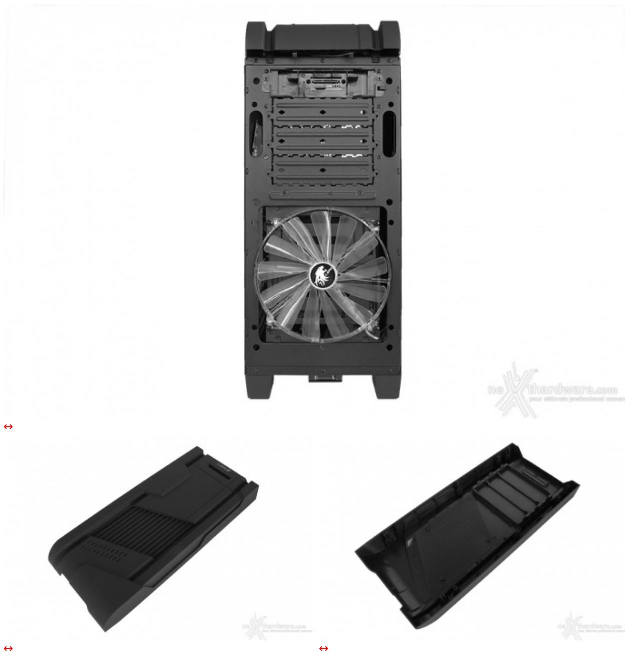
Per rimuovere completamente il frontale in plastica basta far leva verso la parte bassa del case, accedendo così ad una ventola da 200mm con LED blu e al PCB del modulo hot swap.
