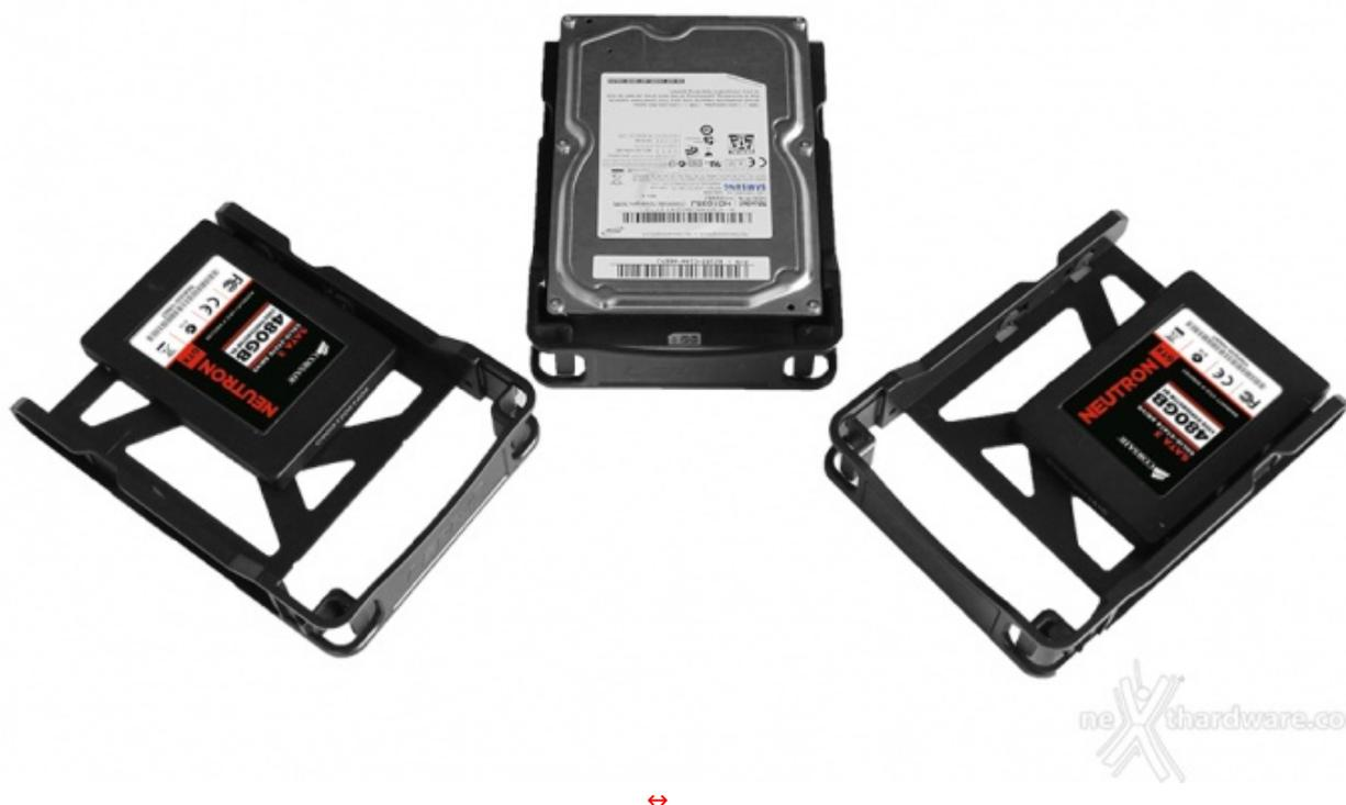
Il posizionamento dei drive all'interno dei cestelli è stato effettuato molto rapidamente, soprattutto per quanto concerne il disco meccanico da 3,5", che non necessita di viti per l'ancoraggio.
