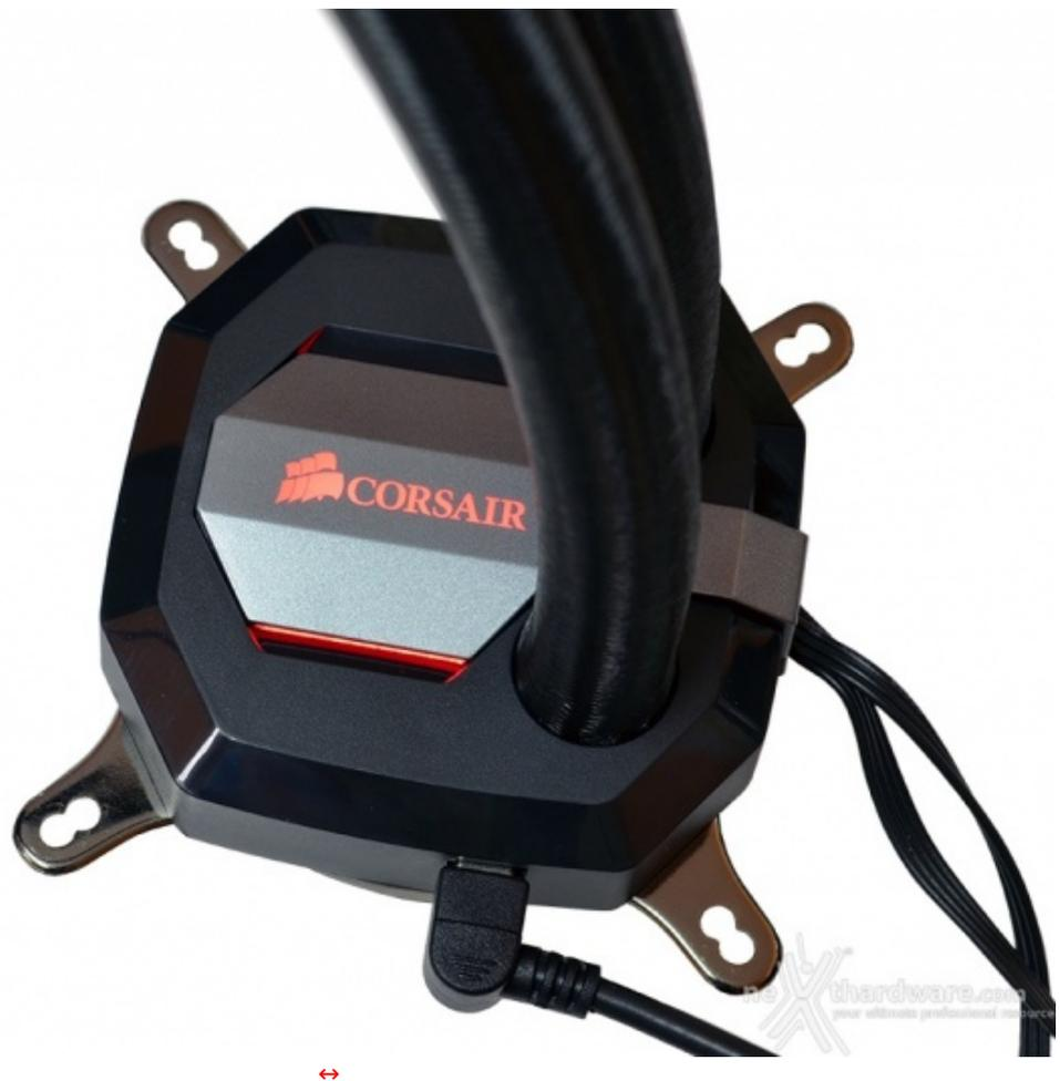
In alto potete ammirare il waterblock del Corsair H100i GTX con l'appariscente colorazione rosso fuoco.
