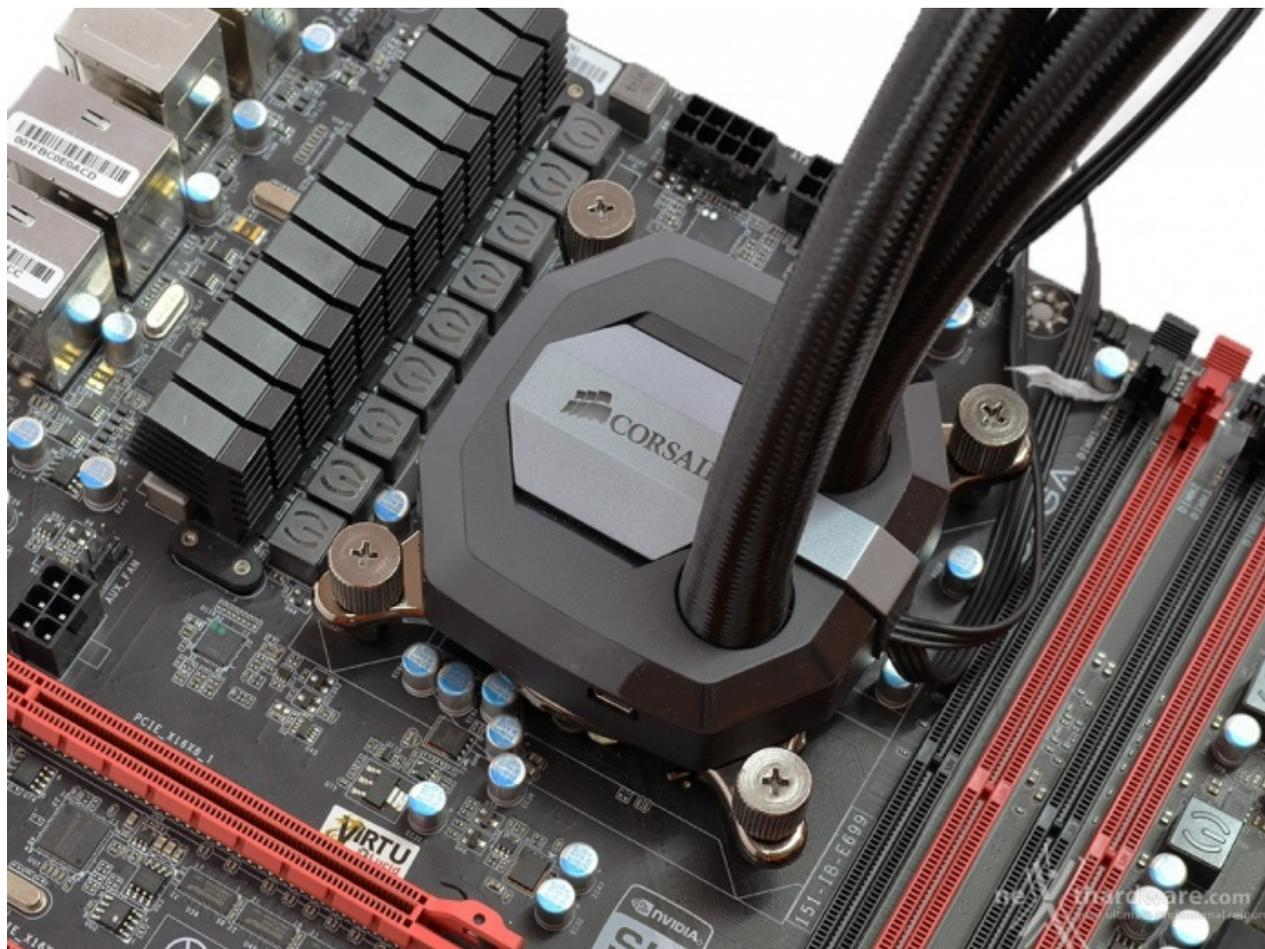
Siamo quindi pronti per ultimare l'installazione, che verrà portata a termine una volta fissate le staffe di ritenzione del waterblock tramite i quattro dadi forniti a corredo.
