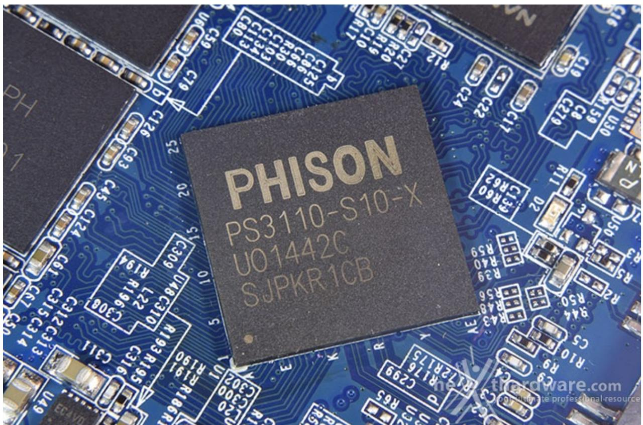
Come già detto in precedenza, il Patriot Ignite 480GB è stato equipaggiato con il più potente dei controller prodotti da **Phison**, ovvero il **PS3110-S10** basato su di un'architettura a quattro core 32-bit, di cui, uno è dedicato alle operazioni di interfaccia con l'host, mentre gli altri tre sono deputati alla gestione dei dati
