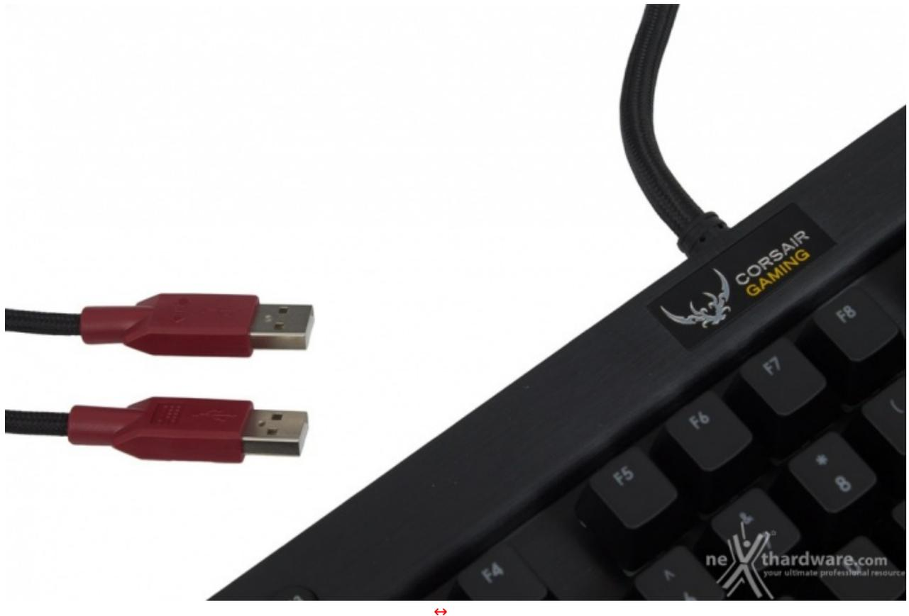
Il cavo di collegamento al PC è uno spesso cordato dalla lunghezza sufficiente (2 metri) a raggiungere il retro del case, con due terminali per il trasporto dati e della corrente necessaria per il sistema RGB.
