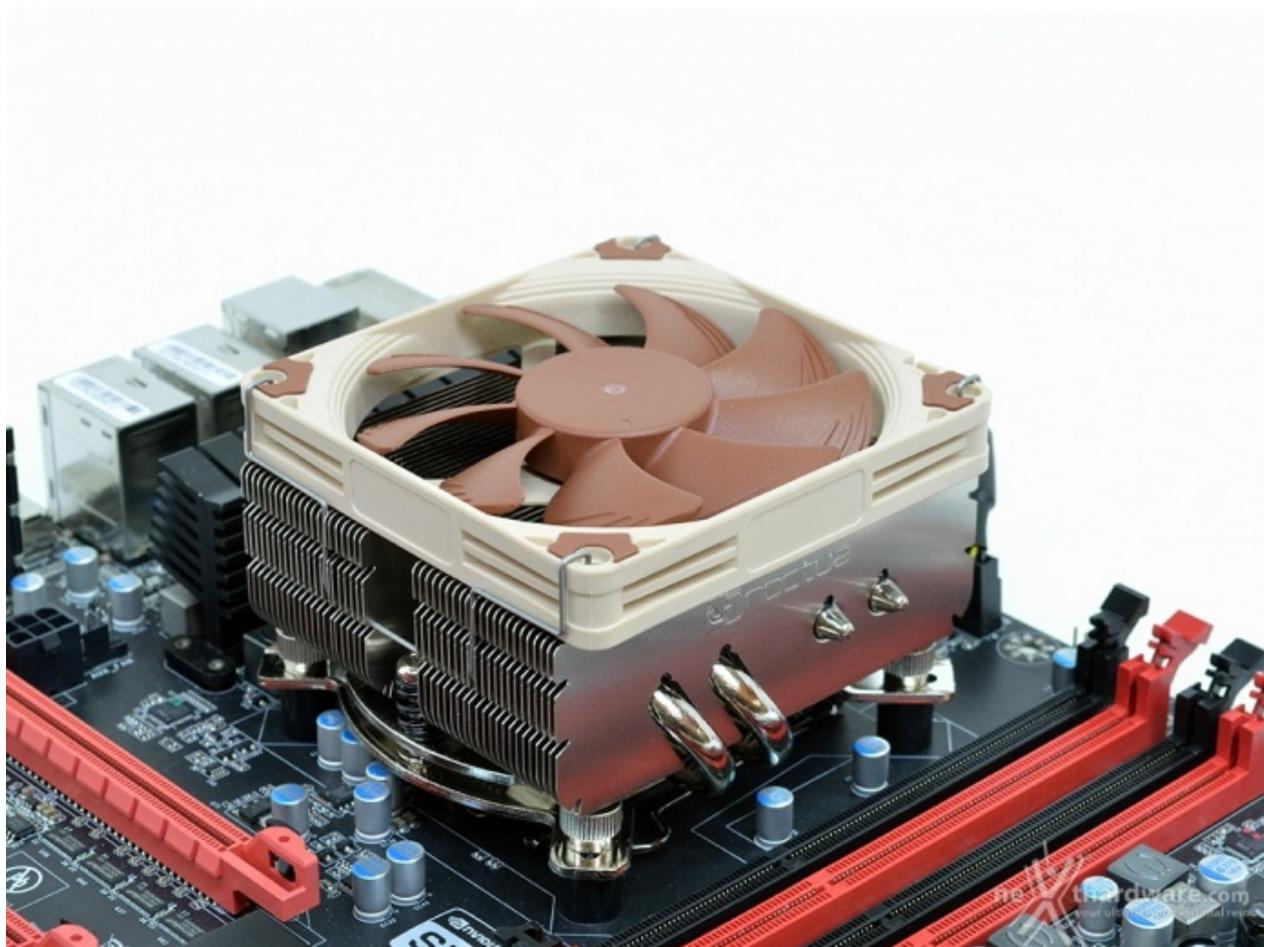
Una volta rimessa la NF-A9x14 PWM al proprio posto, ecco come si presenta il Noctua NH-L9x65 ad installazione terminata.
