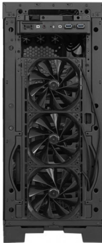
Basterà sostituire un supporto per drive da 5,25", fermato al telaio tramite quattro viti visibili sul frontale, per "prolungare" la serie di fori utilizzabili per l'installazione delle ventole.↔
