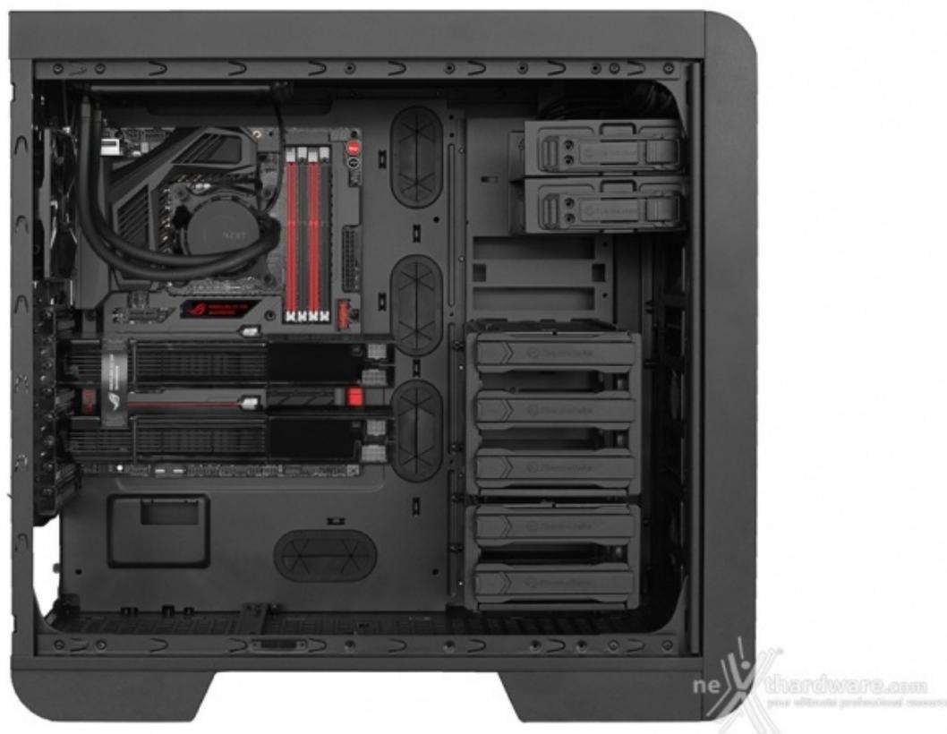
Rimossi quattro copri-slot PCI, fermati al telaio tramite viti zigrinate, è stato possibile montare due schede video dual GPU che, nonostante l'elevata lunghezza, non interferiscono con i cestelli.
