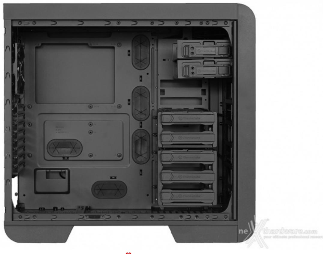
La zona retrostante la CPU contiene, come al solito, uno scasso per l'installazione di sistemi di raffreddamento provvisti di backplate.↔
