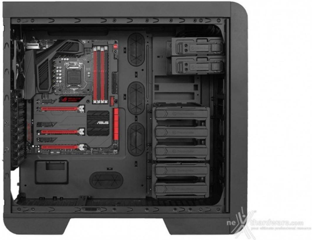
Una volta installata la mainboard è evidente quanto sia facile operare all'interno di questo case: le sue dimensioni, infatti, sono così generose da non ostacolare l'operazione di posizionamento e successivo fissaggio della stessa al relativo vassoio.
