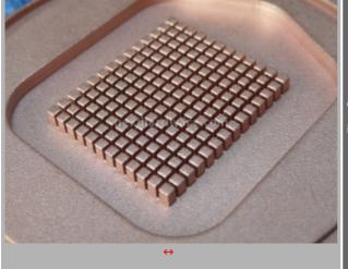
La struttura della base è a micro-pin. La lavorazione è davvero fittissima; ben 168 piedini suddivisi da una griglia di scanalature larghe appena 0,25mm. Il flusso viene incanalato verso il raccordo di uscita tramite la scanalatura che contorna i micro-pin. La lappatura della base è perfettamente a specchio ed è salvaguardata da una pellicola adesiva trasparente.
