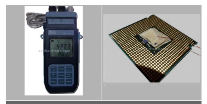
Per svolgere i test di prestazioni abbiamo utilizzato un termometro digitale Delta Ohm HD2127.1. Quest'ultimo monta due sonde Pt100 con precisione al centesimo di grado ed è inoltre fornito a corredo un comodo software per monitorare e registrare le temperature rilevate sul pc. La sonda A è dedicata alla temperatura della cpu mentre la B a quella dell'acqua.
