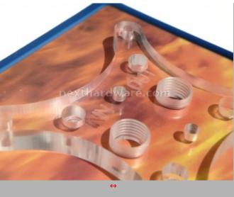
Il top è in plexyglass spesso 1cm. Sopra le filettature sono impresse le diciture IN e OUT così da facilitare il riconoscimento del raccordo di ingresso e di quello di uscita. Sono inoltre presenti due fori da 5mm in cui si può facilmente alloggiare un led per creare dei giochi di luce.
