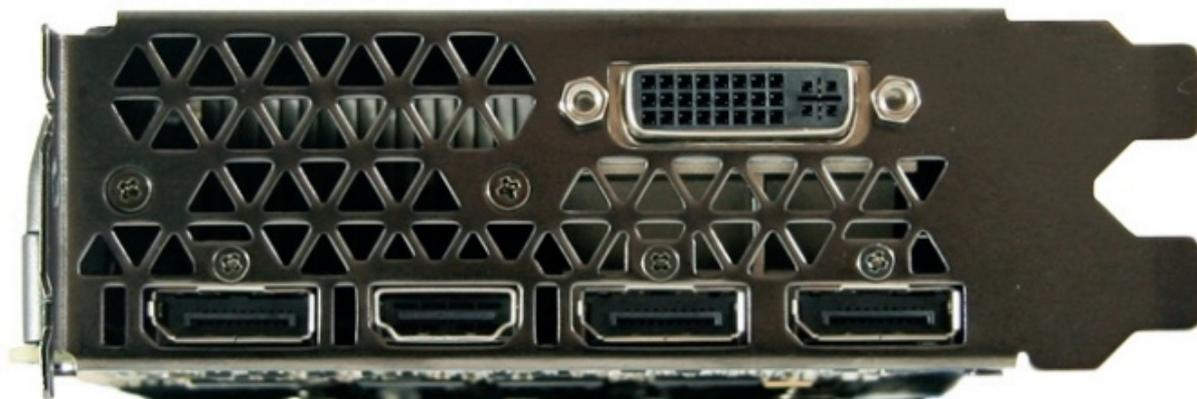
Ricca anche la dotazione di uscite video che conta tre DisplayPort 1.2 compatibili anche con lo standard eDP 1.4, una HDMI 2.0 e una DVI-DL.
