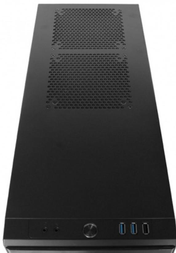
Frontalmente sono posizionati, da destra verso sinistra, una porta USB 2.0, due USB 3.0, il pulsante di accensione con LED di stato incorporato e le connessioni audio per cuffie e microfono.
