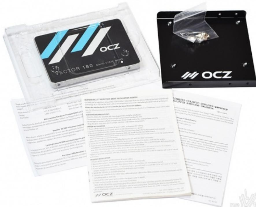
Una volta aperta la confezione possiamo estrarre il contenuto comprendente, oltre ovviamente al nostro SSD, un comodo adattatore per bay da 3,5", un piccolo manuale d'installazione, il seriale per l'attivazione di Acronis True Image HD ed un flyer con le condizioni della garanzia ShieldPlus di OCZ.
