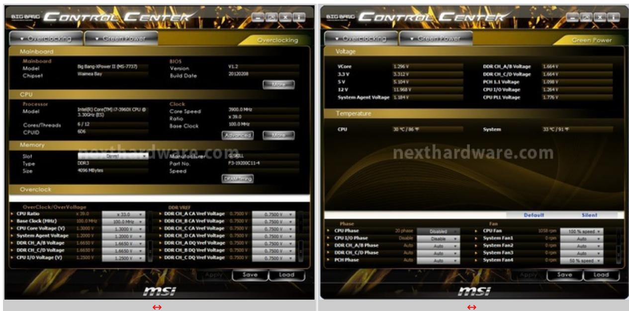
Nella scheda Green Power è possibile prendere visione dello stato del sistema per quanto riguarda la gestione delle fasi di alimentazione, delle temperature e delle tensioni operative dei vari componenti.
