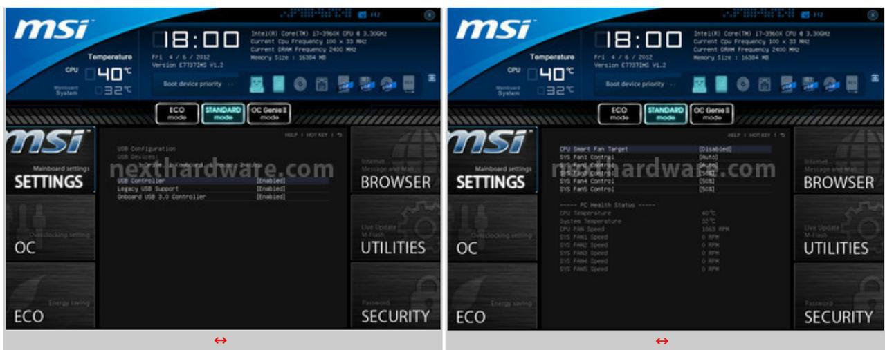
Nel meu SETTINGS troviamo le impostazioni relative ai vari controller (dischi, USB, rete, etc.), l'ora di sistema, la sequenza di BOOT e la possibilità di attivare il protocollo PCI-E 3.0 sugli slot disponibili sulla scheda.
