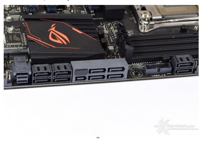
Partendo dall'estrema sinistra troviamo subito la porta U.2 la quale, dividendo la banda disponibile con il connettore M.2 che vedremo in seguito, consente di effettuare una connessione di tipo PCI-E 3.0 x4 garantendo inoltre il supporto al protocollo NVMe.
