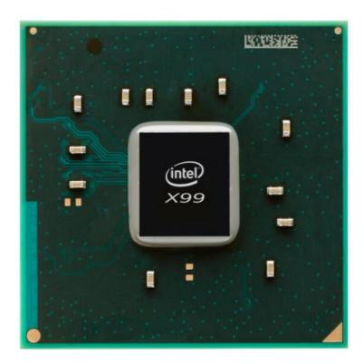
Il chipset Intel X99 è connesso alla CPU con l'ormai tradizionale BUS DMI 2.0, operante in modalità 4x, per una banda complessiva di 20 Gb/s.
