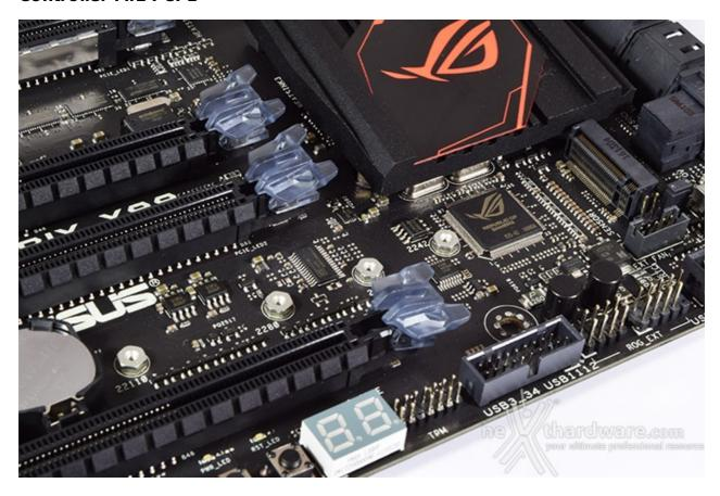
Tra l'ultimo slot PCI-E  $3.0 \times 16$  ed il dissipatore del PCH trova spazio il connettore M.2 che, come detto in precedenza, deve condividere la banda di 32 Gb/s con quello U.2.
