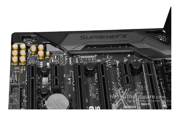
La sezione audio integrata sulla STRIX X99 GAMING è la collaudata ASUS SupremeFX High Definition a otto canali composta dal codec Realtek ALC1150, da due amplificatori operazionali con un'impedenza compresa tra 30 e 300 ohm e da particolari condensatori audio i quali, coadiuvati da una efficace schermatura per le interferenze elettromagnetiche (EMI), sono in grado di fornire un suono limpido con un rapporto segnale/rumore (SNR) pari a 115dB.
