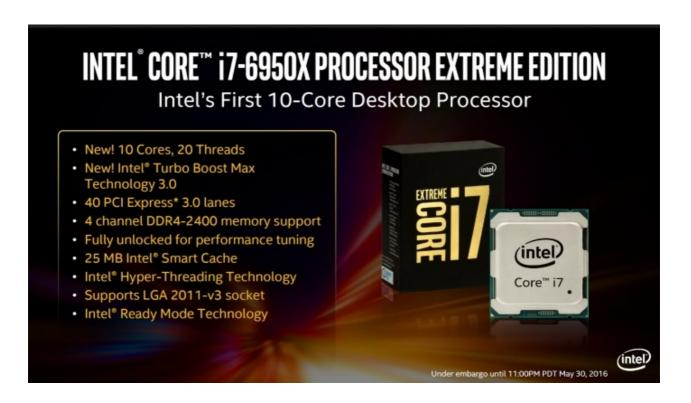
Al pari delle CPU Broadwell con socket LGA 1150, anche quelle Broadwell-E supportano la tecnologia Hyper-Threading in modo da raddoppiare il numero di core logici a disposizione del sistema operativo e,
