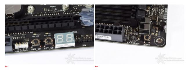
La dotazione di pulsanti e switch onboard della ASUS ROG STRIX X99 GAMING, sebbene non sia alla stregua delle mainboard prettamente dedicate all'overclock, racchiude le funzionalità essenziali per poterne ripristinare il corretto funzionamento in seguito a problemi dovuti ad un errato setup o ad un malfunzionamento generico.
