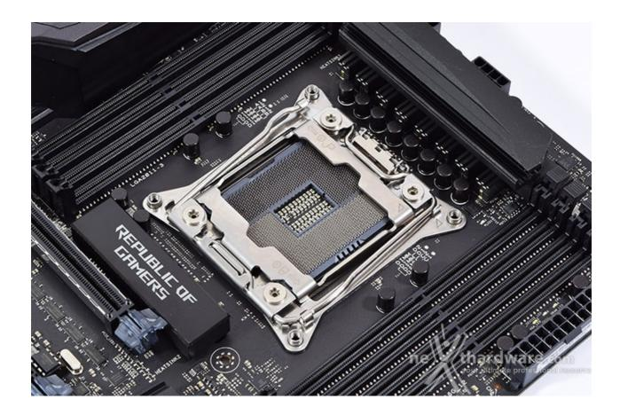
Il sistema di blocco della CPU prevede un sistema a due leve che vanno azionate seguendo un determinato schema, sia in fase di apertura che in quello di chiusura.
