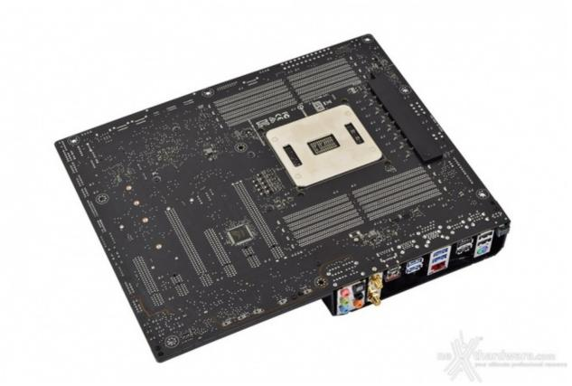
Sul retro del PCB, di colore rigorosamente nero, possiamo osservare i robusti backplate in metallo del socket e di una parte del sistema di dissipazione, le viti di ritenzione dei rimanenti dissipatori presenti sul lato opposto e pochi componenti SMD miniaturizzati (tra cui un chip ROG non meglio identificato) spostati su questo lato al fine di garantire una maggiore pulizia del layout superiore.
